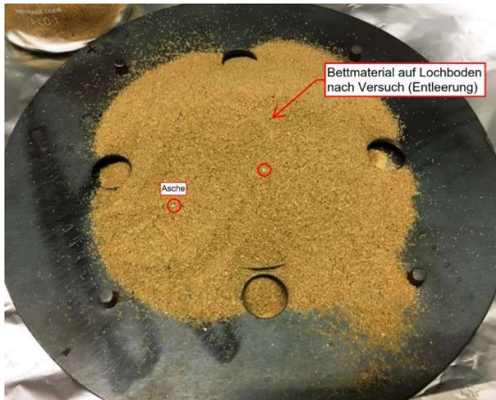
Abbildung 4.8-13: Lochboden mit Bettmaterial (nach Versuch)
