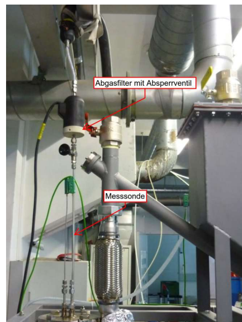
Abbildung 4.8-23: Aufbau Messsonde - V3
