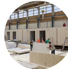
136 Module in Serie im Werk vorgefertigt
