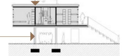
aufgeständert auf 10 Betonsäulen und Technikraumsockel
