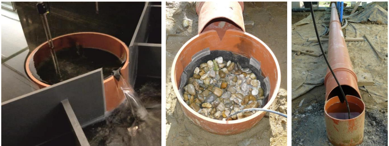
Abb. 6.15: Thomson-Wehr zur Quantifizierung des Sickerwasserdurchflusses aus den Entlastungssäulen; links: Kalibrierung des Messwehres im Labor [88], Mitte: Anschluss der Kiessäule an das Rohr mit integriertem Messwehr, rechts: Rohrleitung zur Ableitung der Sickerwässer (sekundärer Wasserkreislauf).
