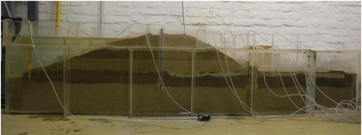
Abb. 5.1: Das kleinmaßstäbliche Dammmodell (Maßstab 1:10).
