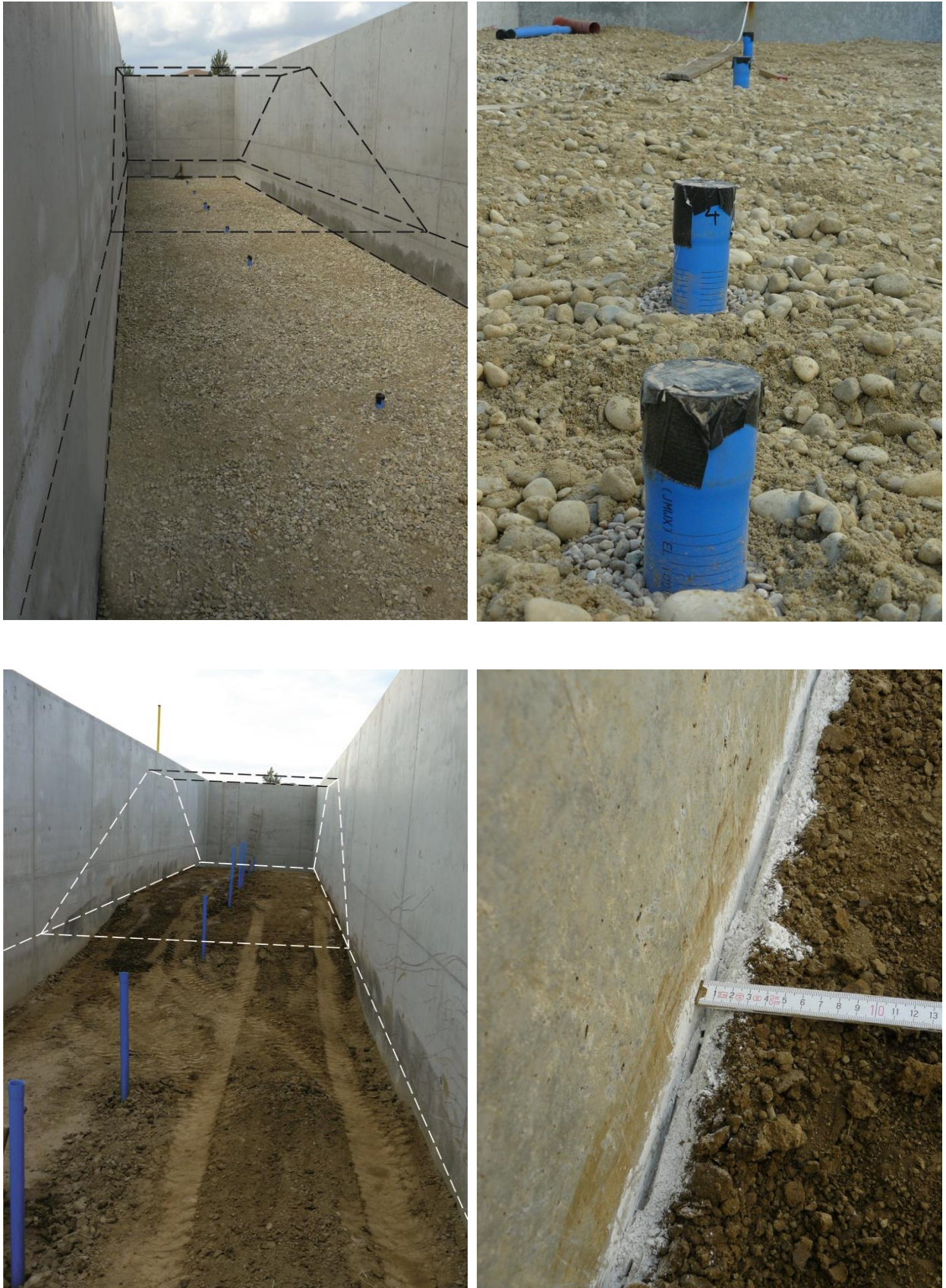
Abb. 6.6: 1:1 Dammodell: sandig-kiesiger Grundwasserleiter nach Einbau inkl. Filterrohre für Beobachtungspegel (oben); schluffig-tonige Deckschicht mit einem Detail der Bentonit-Abdichtung am Rand zur Beckenwand (unten).
