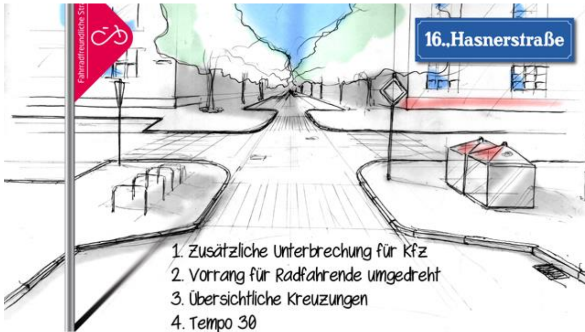
Abb. 5: Eckpfeiler der fahrradfreundlichen Straße in der Hasnerstraße 103
