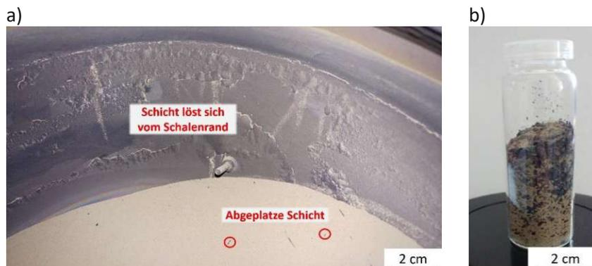
**Abbildung 143** a) Abgeplatze Schicht in Form von Flocken im Substrat
