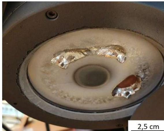
**Abbildung 140** Partiiell aufgeschmolzenes Bi-Target
