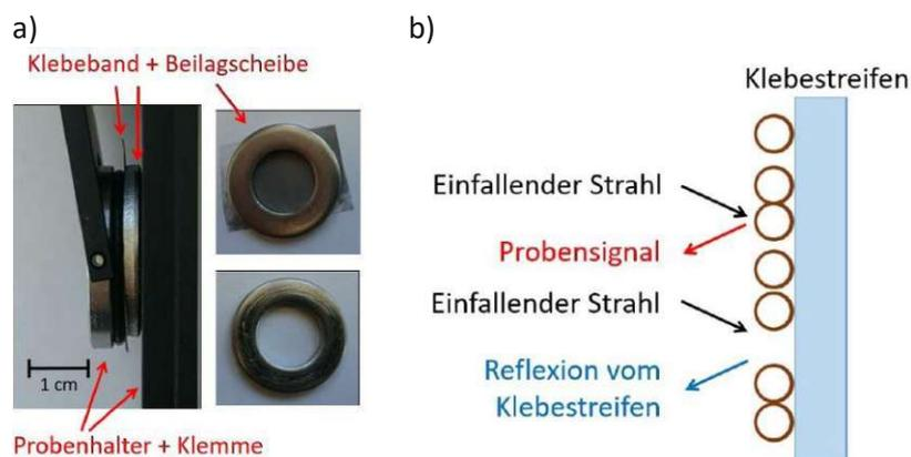
**Abbildung 152** a) Klebeband mit aufgebrachtem Substrat und Substrathalter des Spektrometers [178]
