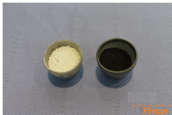
Abbildung 5.16: Das Pulver vor (links) und nach (rechts) der Reduktion mittels Wasserstoff.
