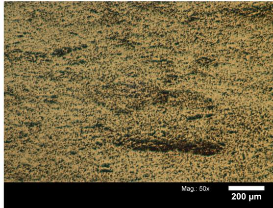
Abbildung 5.17: Mikrostruktur der Probe  $Nb_2O_5 - H2$ : Die Sintertemperatur von 1100°C war viel zu niedrig für das vollständig zu  $NbO_2$  reduzierte Pulver, was zu einer äußerst porösen Struktur führte.
