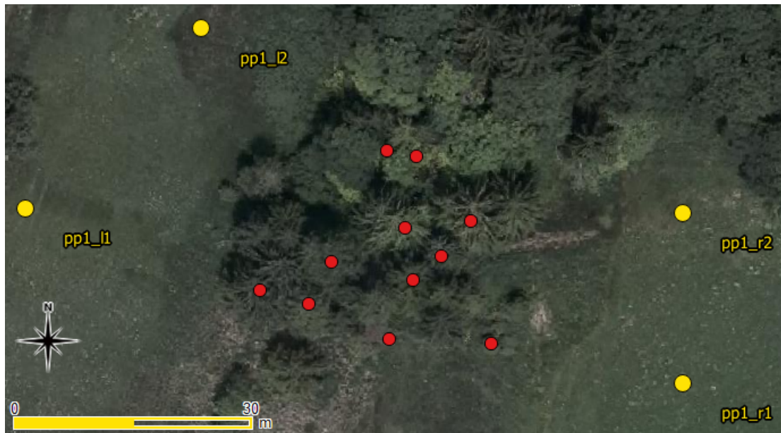
Abbildung 3.2: Lage der Festpunkte durch GNSS-Messung (gelb) und Reflektorfolien zum Referenzieren der Punktwolken (rot)
