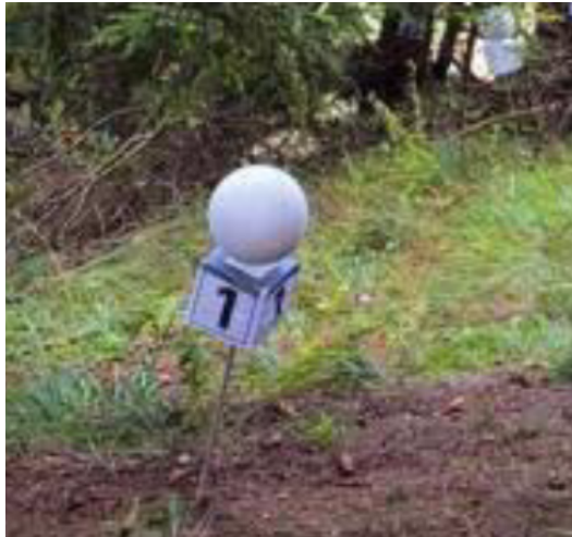
Abbildung 2.8: Verwendete Messkugeln bei der Aufnahme [Wang u. a., 2016]
