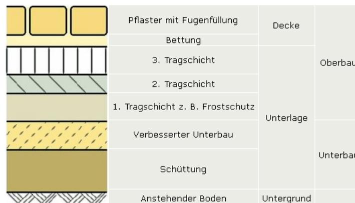
Abb. 1 - Aufbau einer Pflasterdecke <http://www.pflasterdecke.de/technisches/grundlagen/index.htm>
