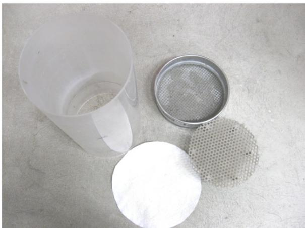
Abb. 17 - Versuchsapparatur - Zylinder, Geotextil, Platte, Sieb
