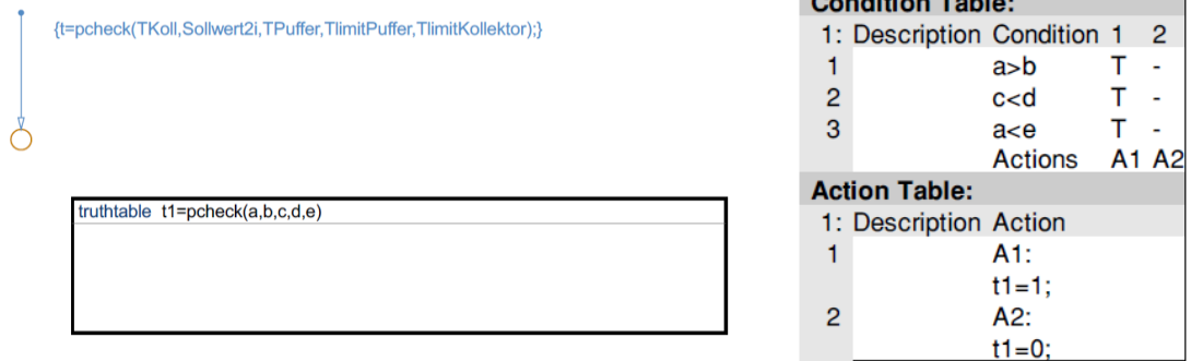
Abbildung C.15: Reglermodell Typ 2, Umsetzung in Stateflow 2: Verweis auf eine Wertetabelle mit Systemcheck (Prüfung der Sollwerte)
