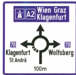
Abb.60 Vorwegweiser für einen Kreisverkehr [72]
