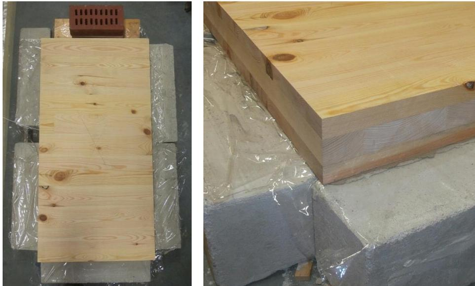
Abbildung 24 – Draufsicht der allseitigen Lagerung (links), einfacher Lagerung im Detail (rechts).
