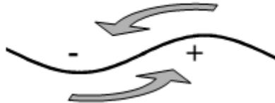
Abbildung 10 - Wellental und -Berg einer Biegewelle. Die Pfeile zeigen die Luftverschiebung hin zum Wellenthal an. [23]
