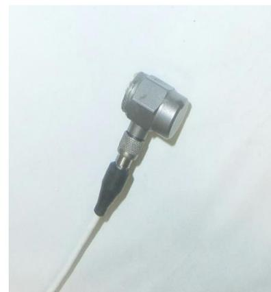
Abbildung 25 - Beschleunigungsaufnehmer
