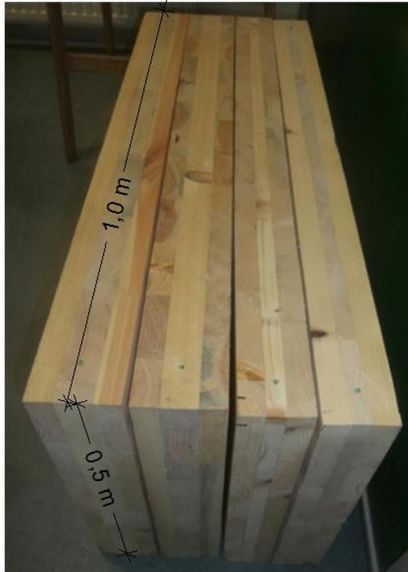
Abbildung 31 - - Brettsperrholzplatten der Firma Stora Enso von links nach rechts: 1. CLT-L3s 100mm, 2. CLT-C3s 100mm, 3. CLT-C3s 80mm, 4. CLT-L3s 80mm.
