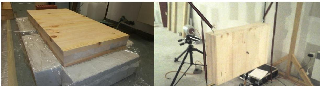
Abbildung 23 - Auflagerbedingung: einfach gelagert (links) am Institut für Bauphysik und Schallschutz der TU Wien, frei gelagert (rechts) am Austrian Acoustic Center der Holzforschung Austria.
