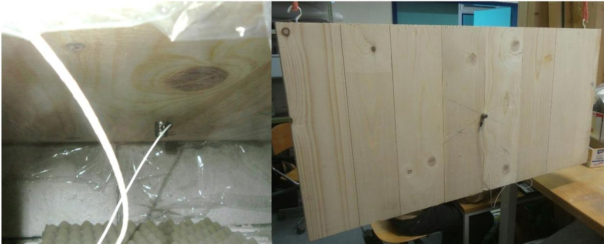
Abbildung 26 - Position des Beschleunigungsaufnehmers bei allseitig gelagerter Platte auf der Unterseite der Platte (links) und aufgehängter Platte (rechts). Diese Messung wurde am Institut durchgeführt.
