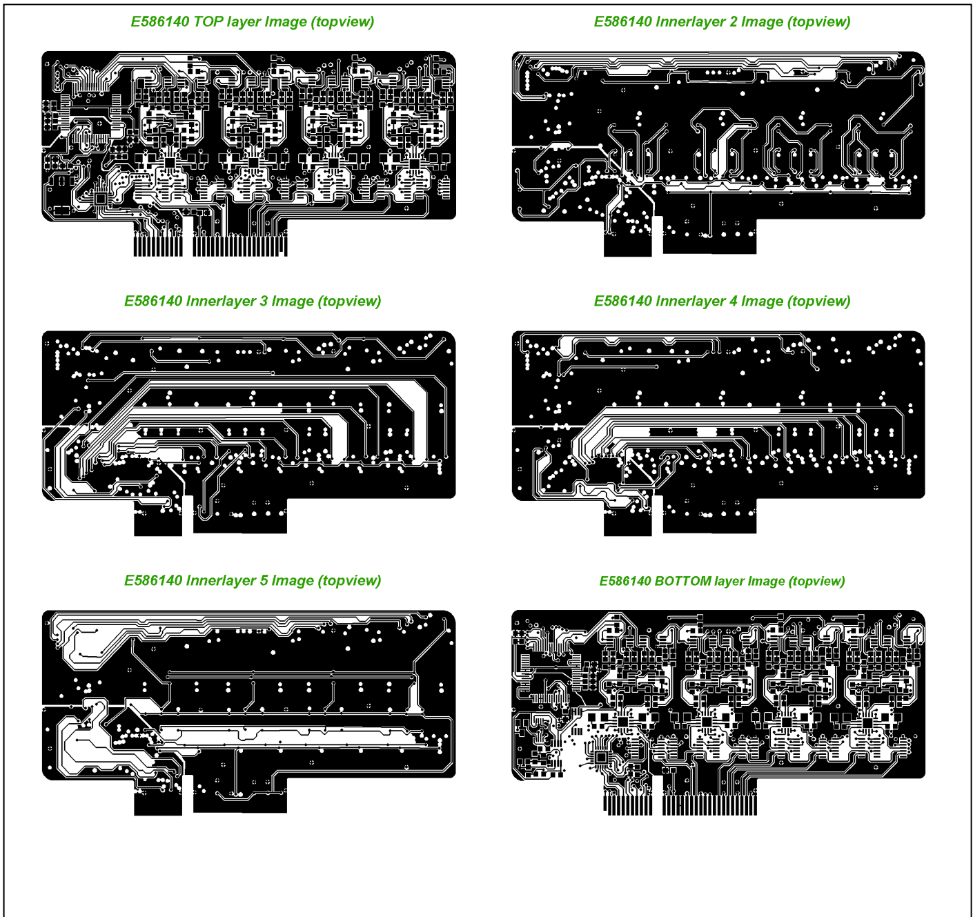
Abbildung 59: Leiterplattenaufbau der einzelnen Lagen des in dieser Arbeit entwickelten Vorverstärkers.
