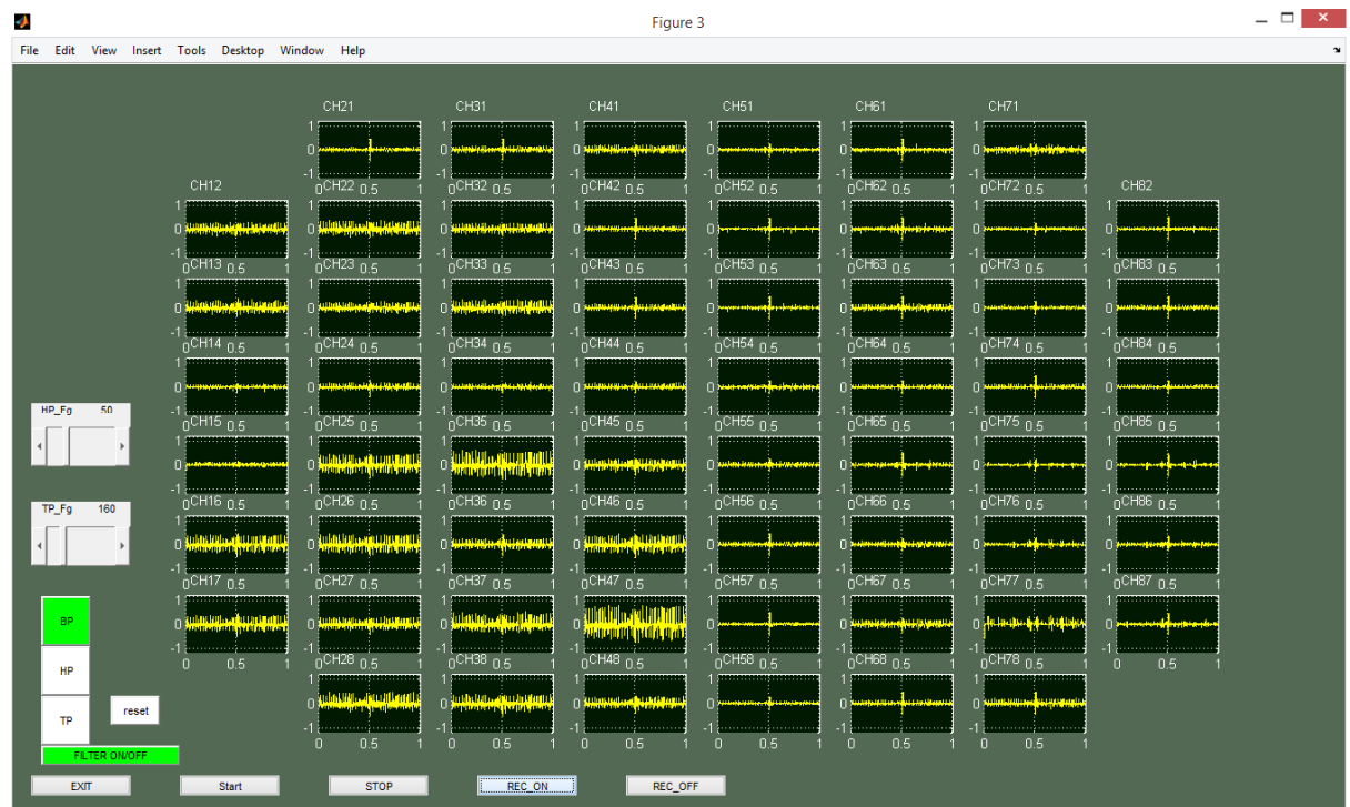
Abbildung 35: Aufzeichnung von 60 Kanälen bei aktivem digitalen Filter.
