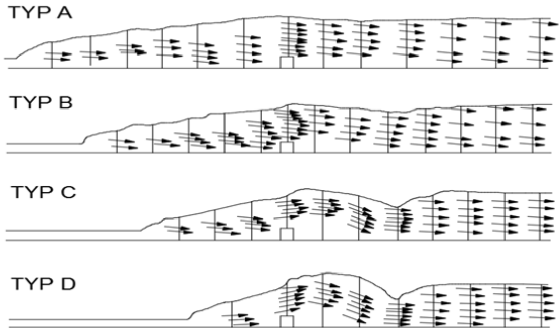
Abbildung 5.14 - Typen von Wechselsprüngen bei Tosbecken mit Schwellen (aus Hager/Sinniger 1989)
