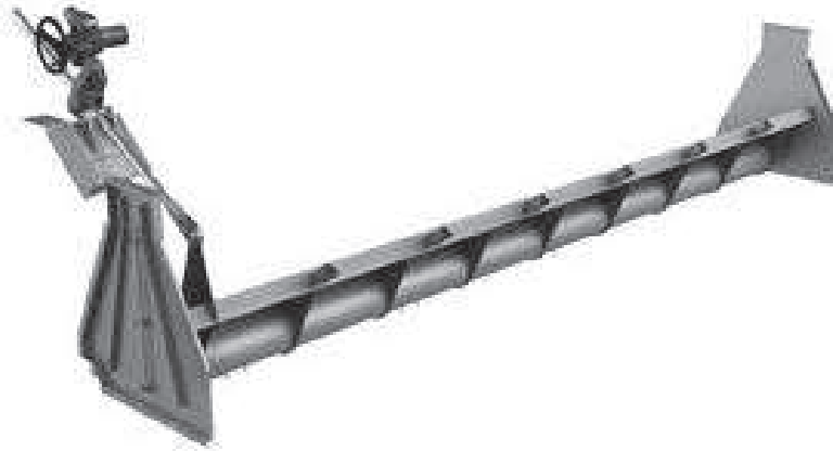
Abb. 5.4 Konstruktionsdarstellung einer Fischbauchklappe [14]
