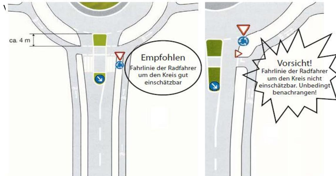
**Abbildung 36:** Links: konzentrischer Radweg um Kreisverkehr mit bevorzogter Radfahrerüberfahrt
