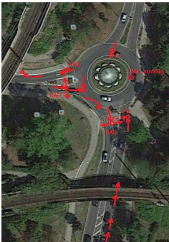
**Abbildung 140: Kreisverkehr I I-11 Kollisionsdiagramm**
