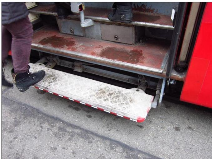
Abbildung 126 Schwenkstufe an der Straßenbahn, eigene Aufnahme
