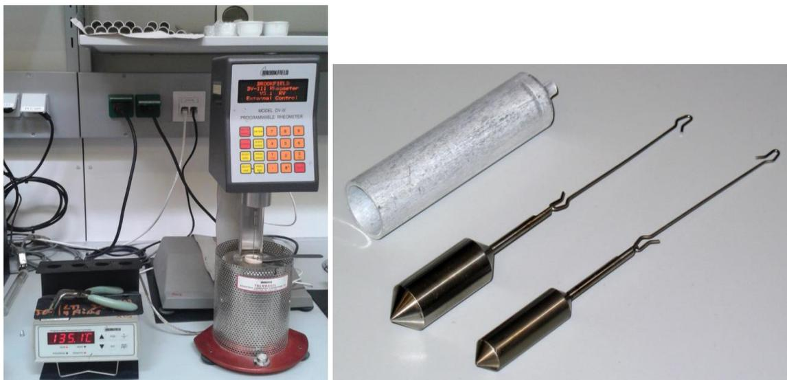
Abbildung 23: Links: Rotational Viskometer, Rechts: Aluminiumhülse und Spindel[18]
