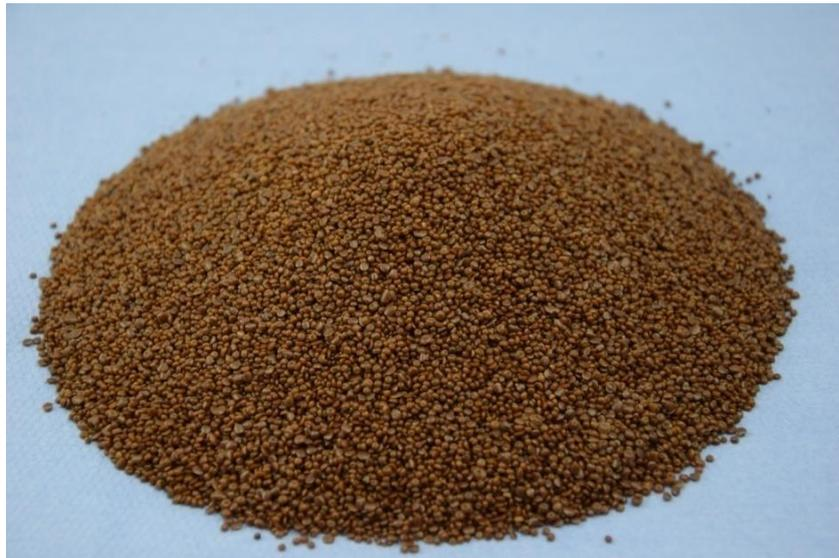
Abbildung 14: Montanwachs Granulat
