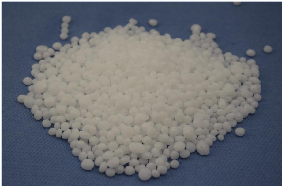
Abbildung 15: Polyethylenwachs Granut
