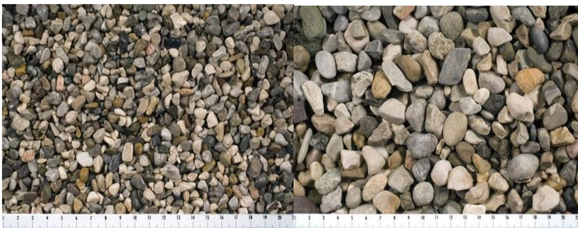
Abbildung 11: links ist Rundkorn 4/8 mm und rechts ist Rundkorn 8/16 mm [8]
