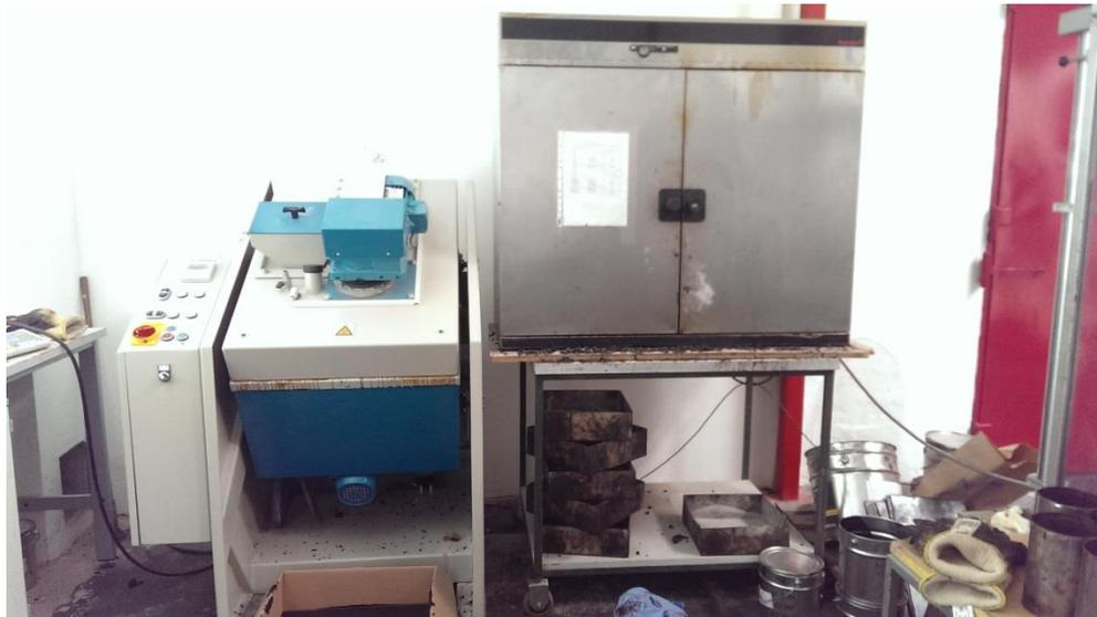
Abbildung 26: Mischer und Wärmeschrank
