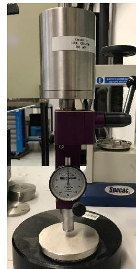
Abbildung 21 - Versuchsaufbau der Härtemessung
