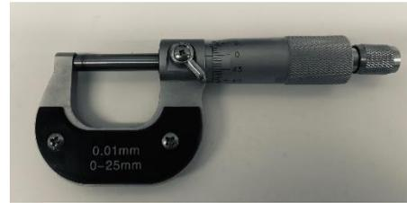
Abbildung 17 - Verwendete Messschraube
