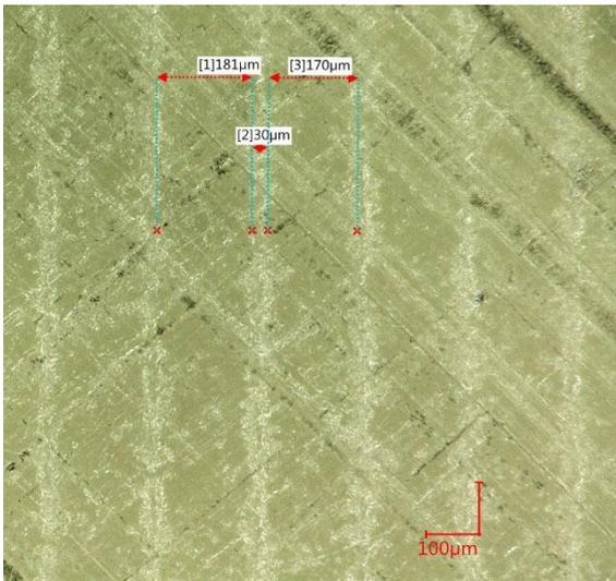
Abbildung 41 - Detailaufnahme der Probekörper mit 45° Orientierung
