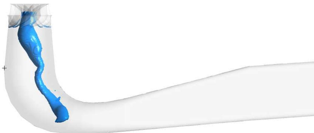
Abbildung 6.11: Kavitationsgebiete dargestellt über Dampfolumen-Isosurface ( $V = 10\%$ ) bei einem (experimentell) simulierten reduzierten Saugrohrgegendruck
