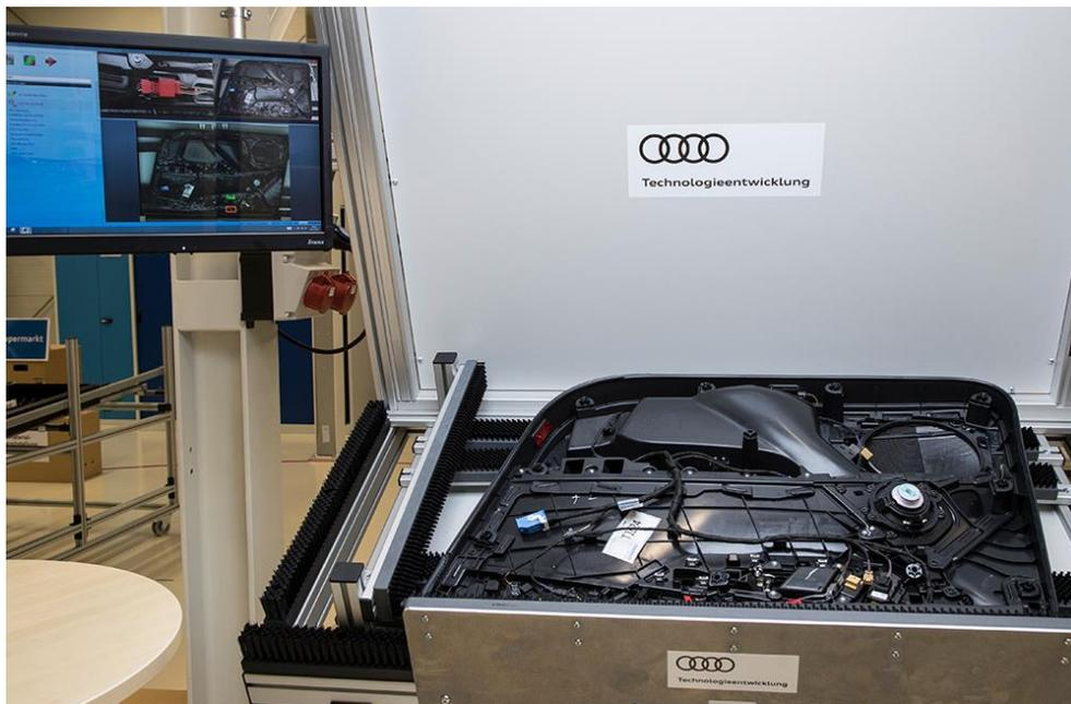
Abbildung 15: Der schlaue Klaus im Einsatz bei der Türmontage des Audi A4<sup>237</sup>
