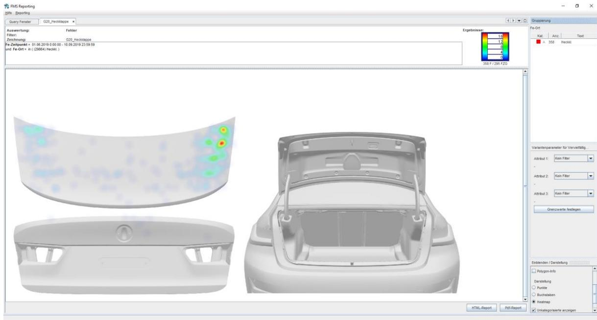
Abbildung 19: FMS Auswertung der Heckklappe zur Darstellung von Fehlerschwerpunkten
