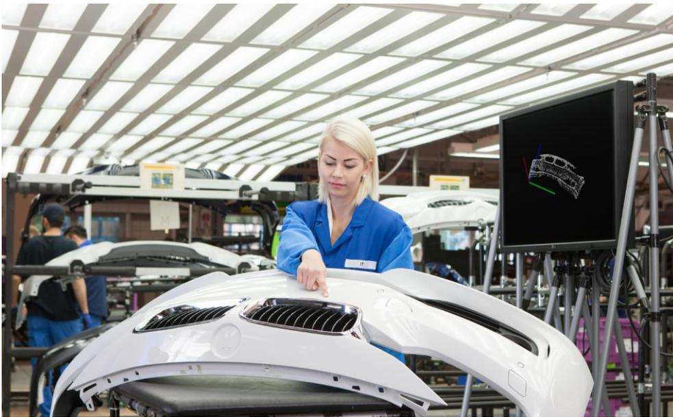
Abbildung 13: Qualitätsprüfung per Gestensteuerung im BMW Werk Landshut<sup>232</sup>
