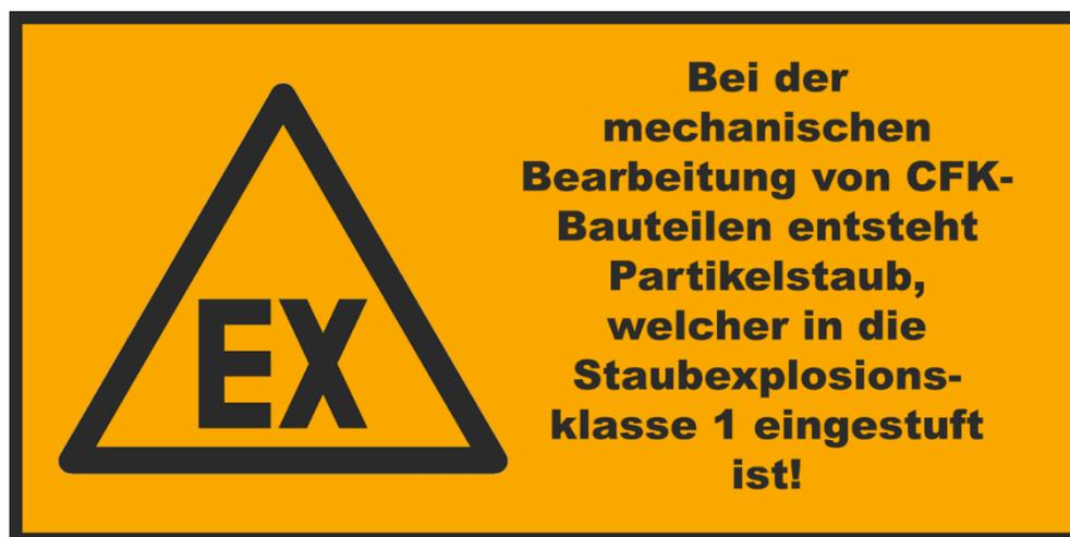
Abbildung 37: Explosionsgefahr – Kombinationszeichen
