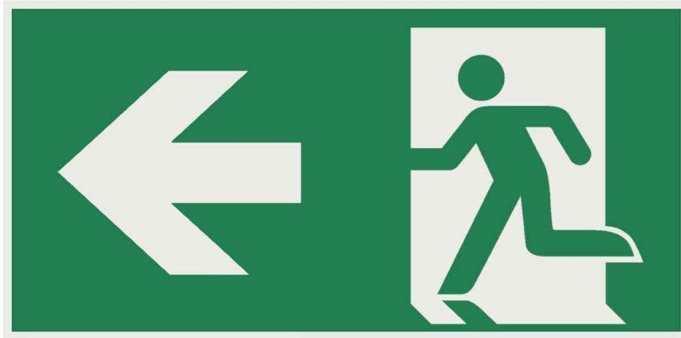
Abbildung 46: Fluchtweg in Richtung "links" (DIN EN ISO 7010, 2012, S. 19)
