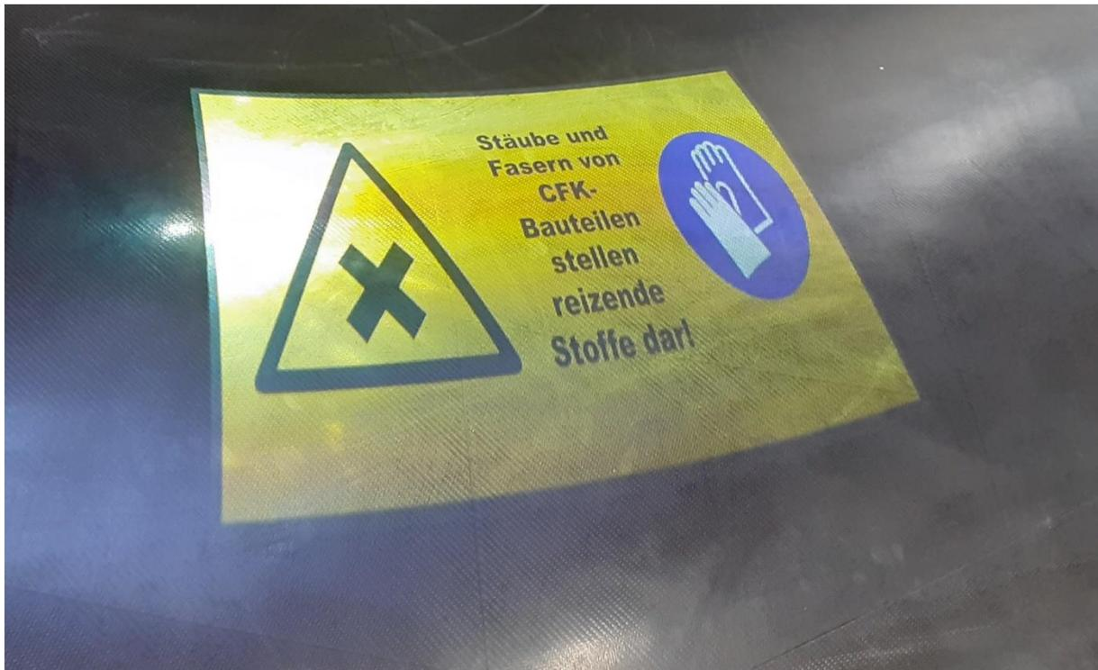
Abbildung 70: Bereitstellung Hautkontakt mit Handschutz Kombinationszeichen
