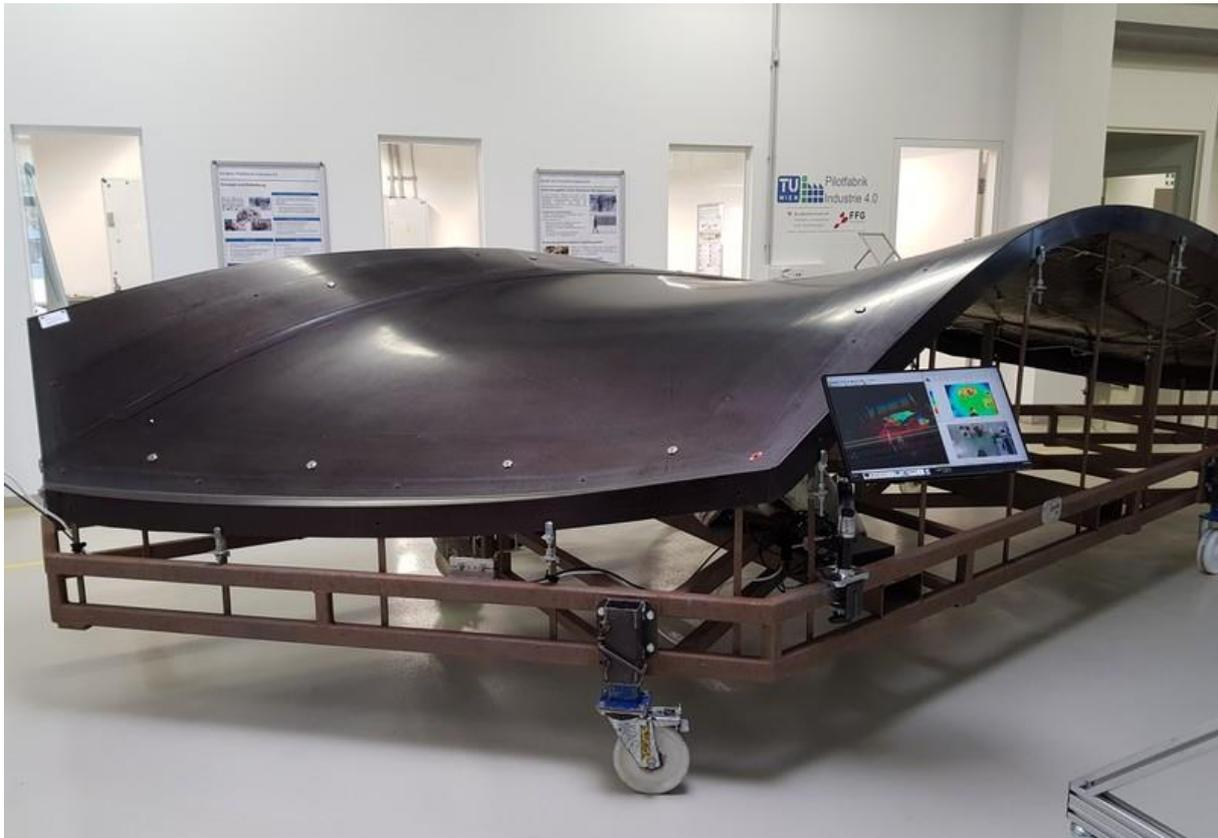
Abbildung 4: Winglet-Werkzeug in der Pilotfabrik Industrie 4.0 der TU Wien<sup>5</sup>
