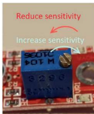
Abbildung 52: Potentiometer für Sensibilität des Hall-Sensors
