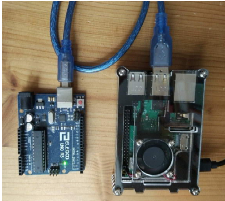
Abbildung 28: Serielle Schnittstelle zwischen Arduino und Raspberry PI – Versuchsaufbau
