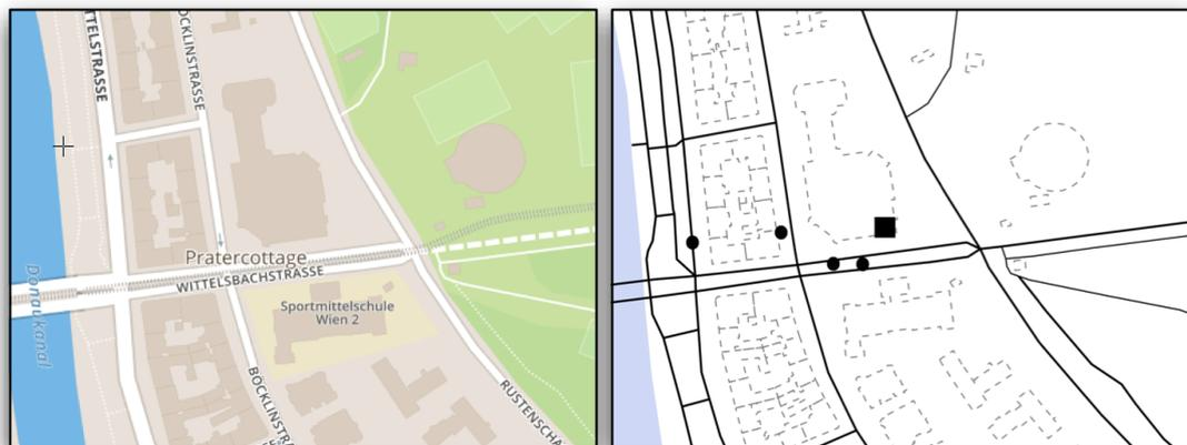
Abbildung 5.14: Ausschnitt der Karte aus Open Street Map und nach dem Umwandeln durch die Software CEAT. Links das Original aus Open Street Maps, rechts das fertige Bild für den Druck auf dem Braille-Drucker.
