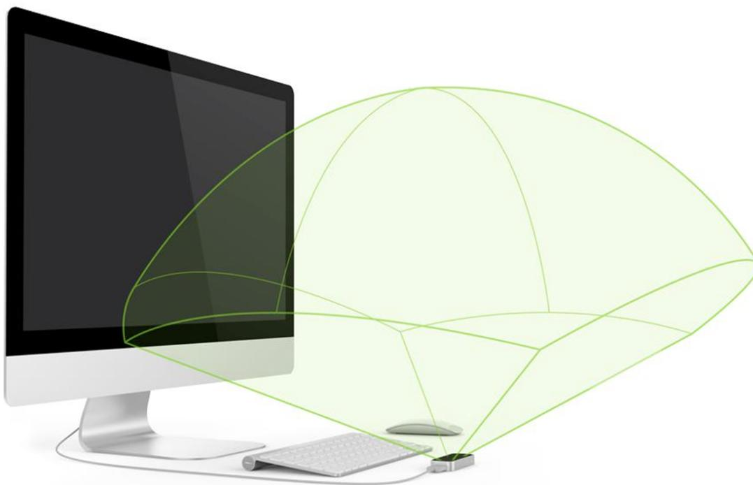
Abbildung 4.1: Darstellung des Interaktionsraumes bei der Verwendung des Leap Motion Sensors[Leab].
