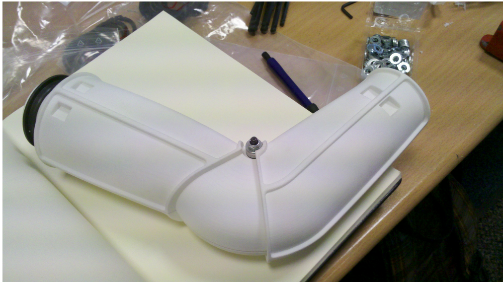
Abbildung 5.10: Der erste Prototyp besteht nur aus den Ellbogen und Unterarmteilen.
