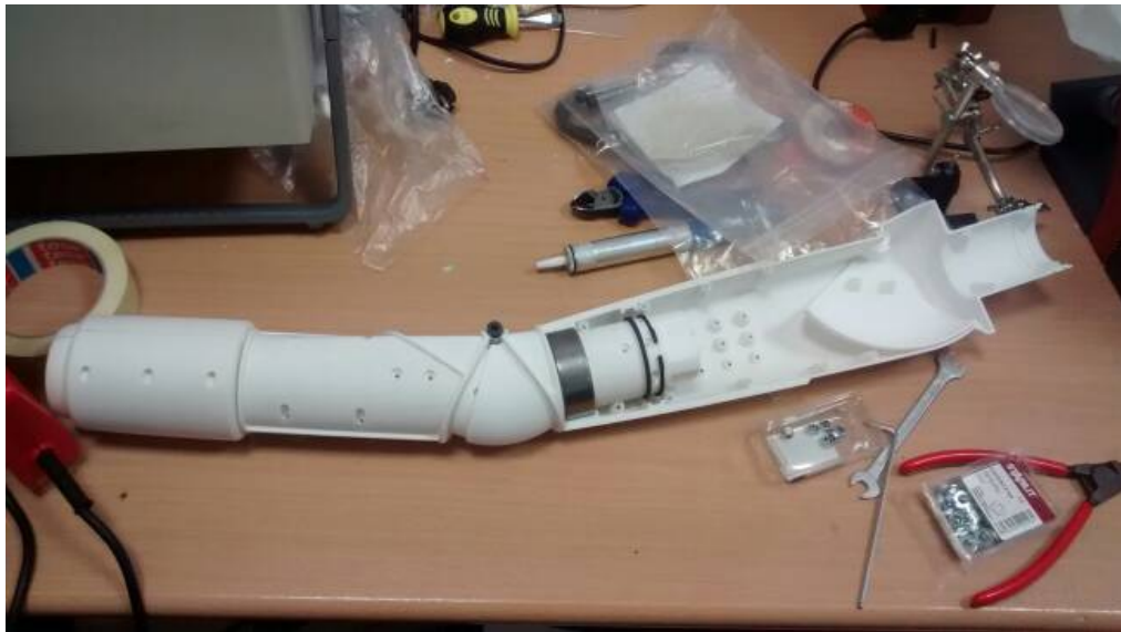
Abbildung 5.19: Der dritte Prototyp wurde komplett mit dem SLS-Verfahren aus Kunststoff hergestellt.
