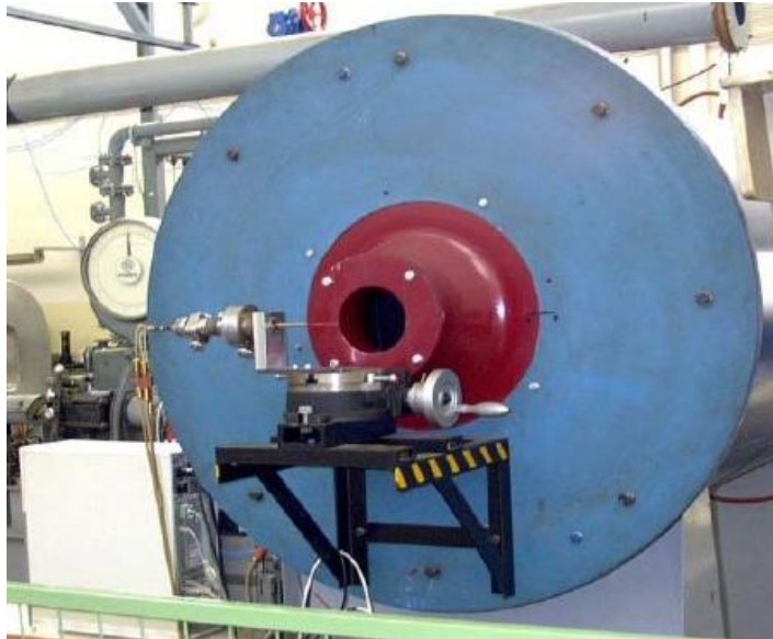
Abbildung 5.2: Einspannung der Sonde vor der Düse [3]
