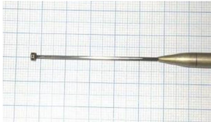
Abbildung 3.5: vergrößerte Kopfansicht der AVA Trapezsonde Nr. 110 [3]
