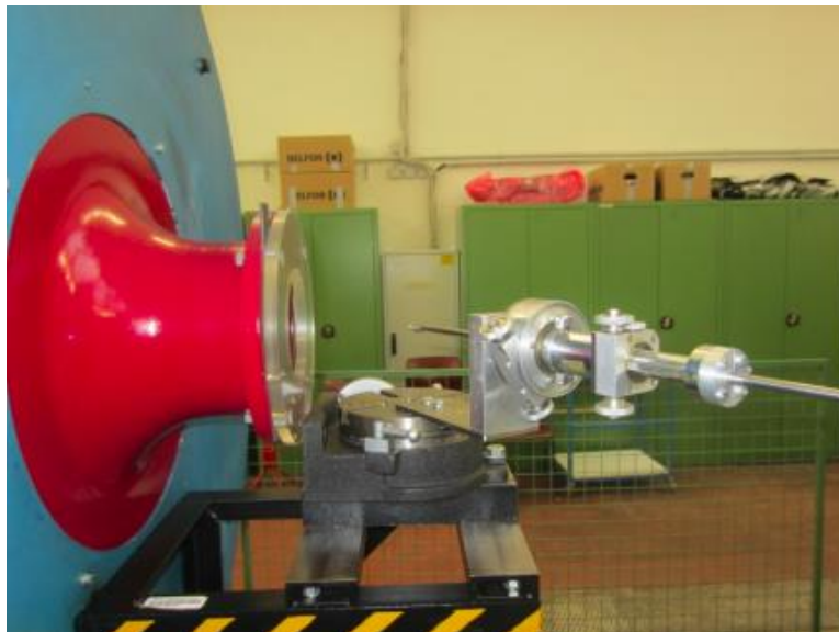
Abbildung 5.3: Einspannung der Sonde vor der Düse [2]
