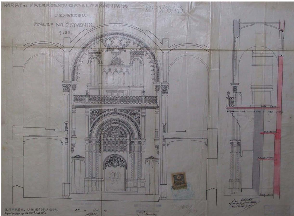
Pl. 4.05 – Oton Goldscheider, Querschnitte (durch das Hauptschiff und durch den Ausbau) mit einer Darstellung eines Umbaus des Thoraschrein und Ausbau der Orgelgalerie (1:50), Jan. 1904.
