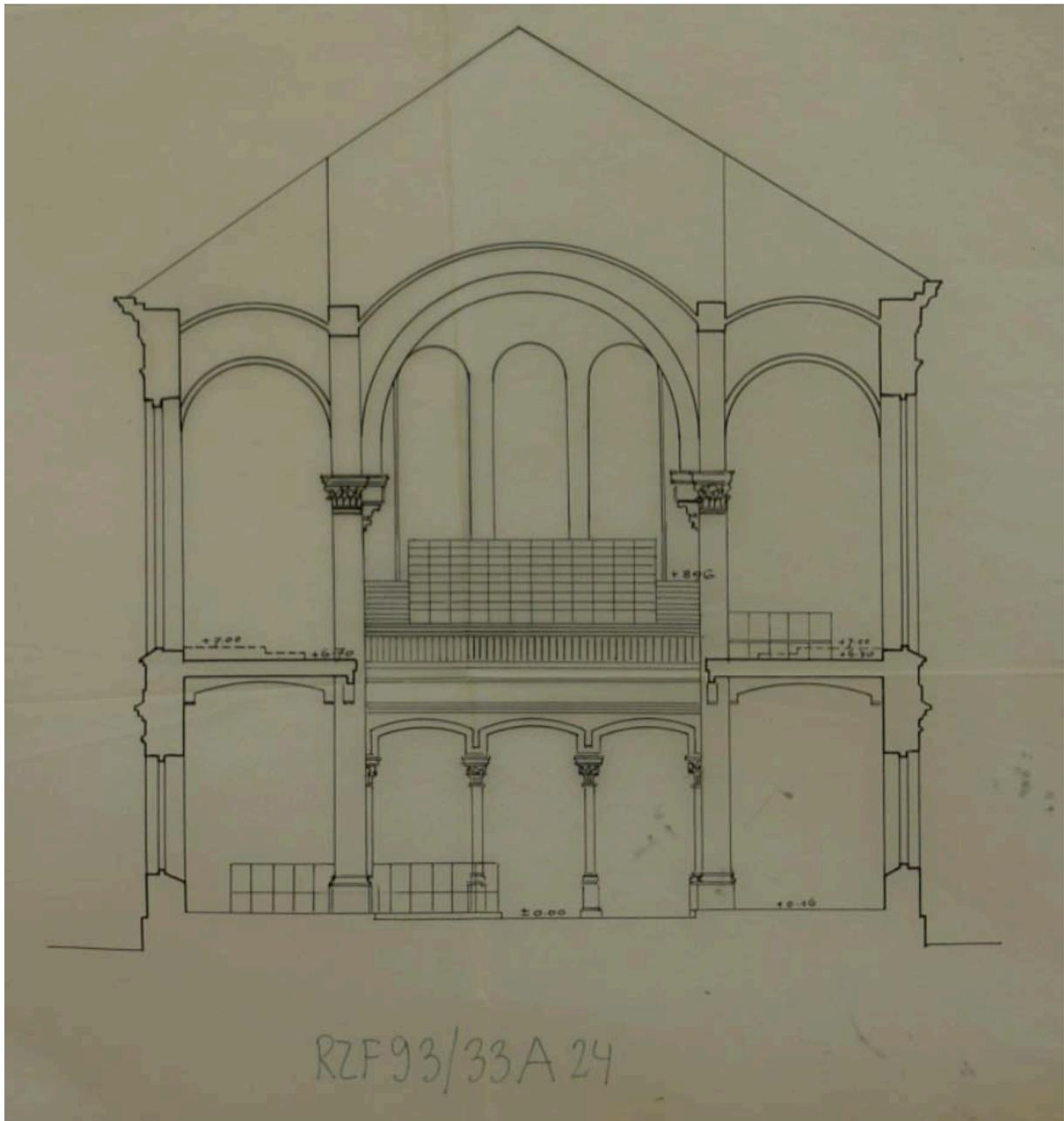
Pl. 4.08 – Oton Goldscheider, Kotierter Querschnitt (Richtung Eingang) [Ausschnitt] (ohne Maßstab [1:100]), 5. Juni 1921.
