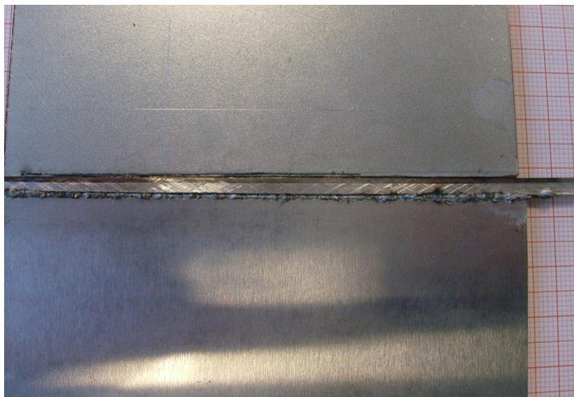
Abbildung 5-33 Sekundärschweißung mit Zusatz, Rückseite; oben Stahlschweißung, unten Aluminiumschweißung
