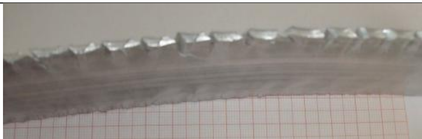
Die Aluminiumkante zeigt ein gezacktes Muster von Kantenrisse; Ansicht von oben
