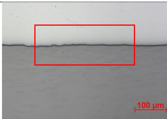
Leichte Einrisse in Stahl; Detail rechts
