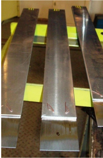
Abbildung 4-8 Gebürstete Proben verbunden mit Kupferdraht um die Position zu sichern
