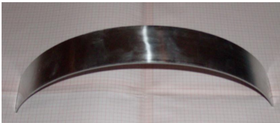
Abbildung 5-3 Walzplattierter Bimetallstreifen (oben Aluminiumseite, durchgehend mit der untenliegenden Stahlseite verbunden, kein Aufklaffen in der Mitte wie bei Abbildung 5-2)
