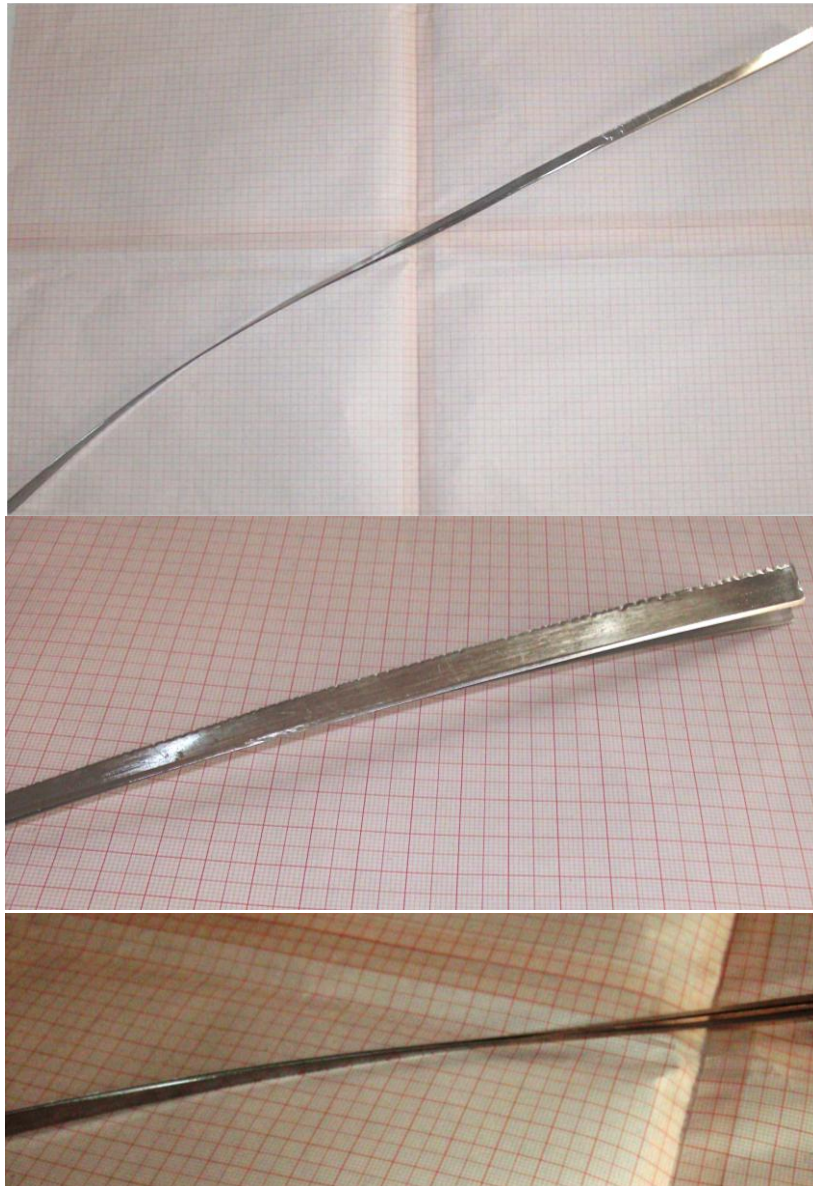
Abbildung 5-23 mit Tafelschere geschnittener Streifen: verdrillt und geöffnet
