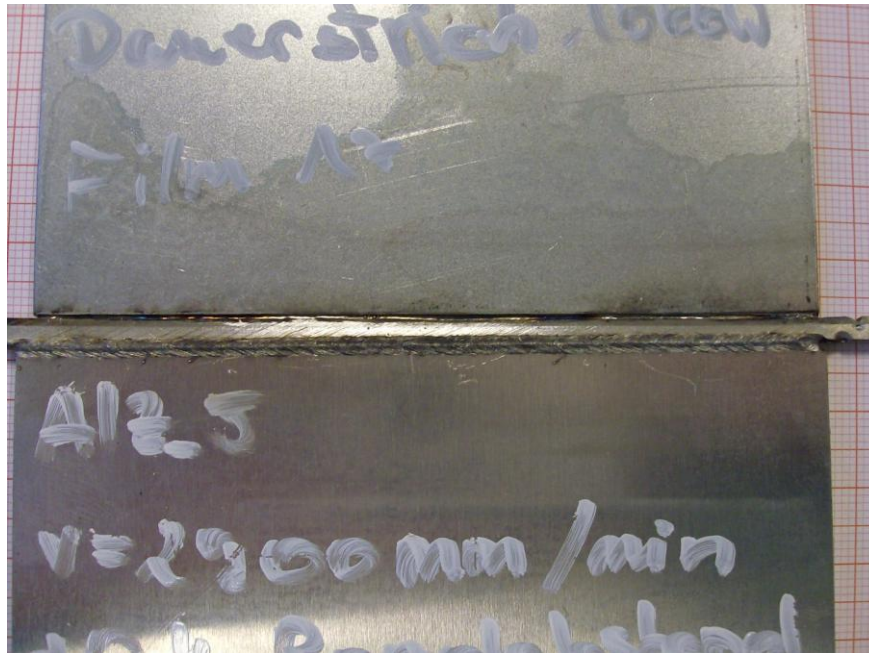
Abbildung 5-32 Sekundärschweißung mit Zusatz, Vorderseite; oben Stahlschweißung, unten Aluminiumschweißung
