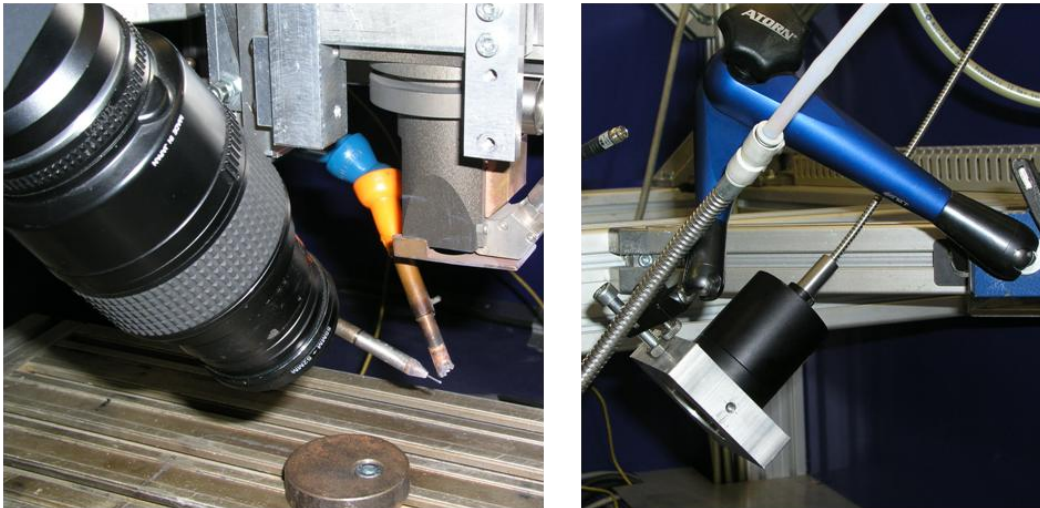
Abbildung 4-28 Links: Hochgeschwindigkeitskamera; Rechts: Beleuchtungslaser
