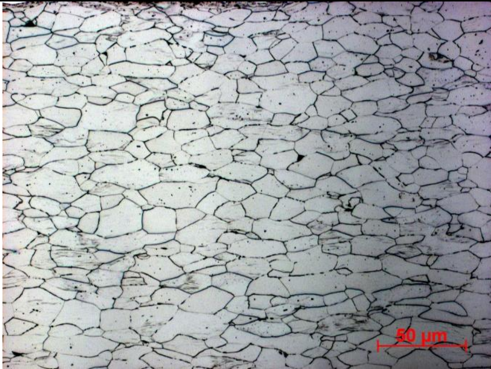
Ferritkörner des Stahls
