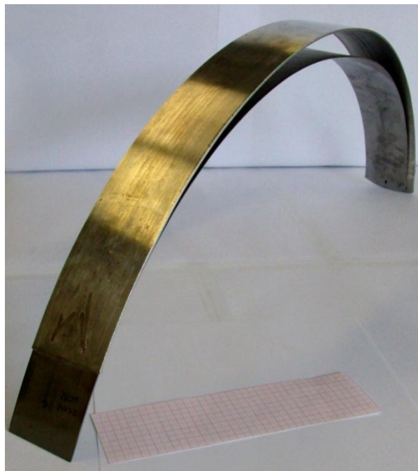
Abbildung 5-2 Gelöste Verbindung von Stahl und Aluminium
