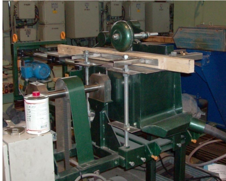
Abbildung 4-6 Bürstmaschine mit eingespannter Probe
