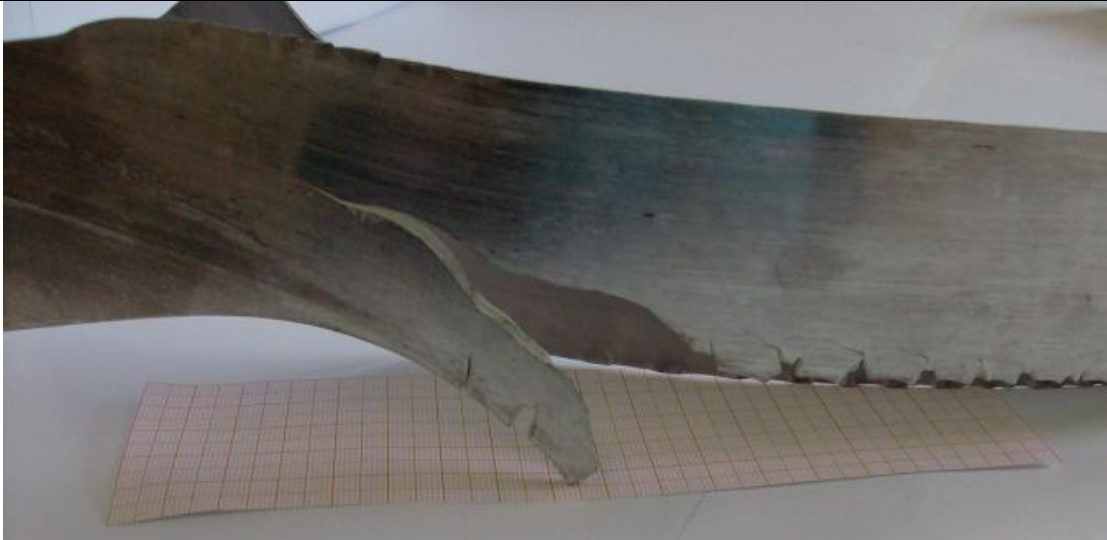
Aluminiumaußenseite: starker Einriss am Ende des Metallstreifens
