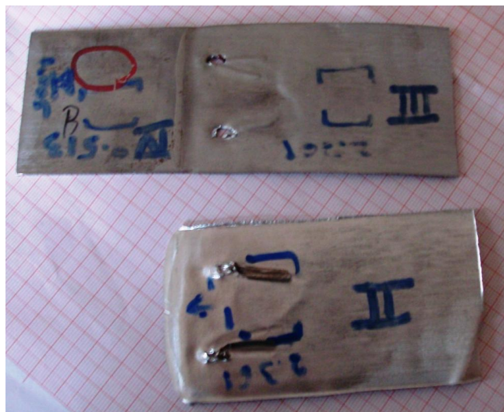
Abbildung 5-6 Probe B: Al innen, gebürstet – Messung II (Probe unten); St innen – Messung III (Probe oben)
