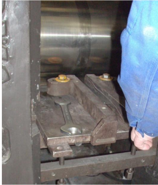
Abbildung 4-9 Beginn der Plattierung durch Einzug der Bleche im Walzspalt
