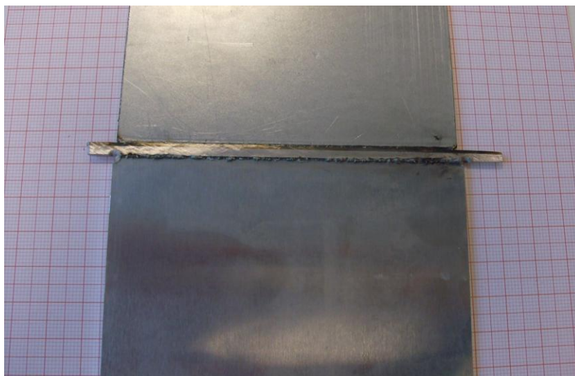
Abbildung 5-31 Sekundärschweißung ohne Zusatz, Rückseite; oben Stahlschweißung, unten Aluminiumschweißung
