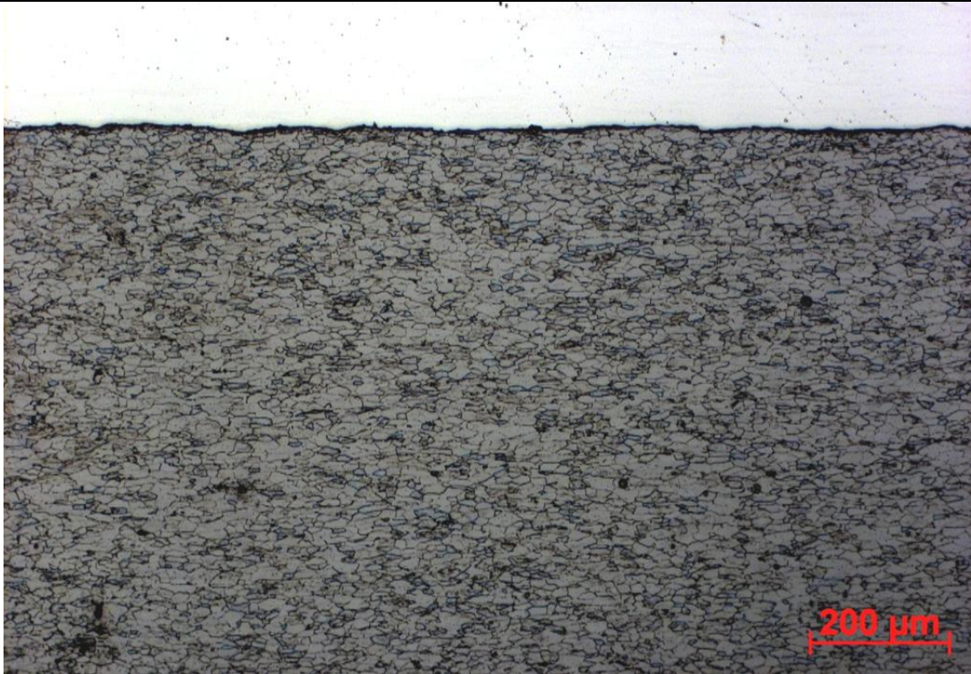
Geätztes ferritisches Gefüge im Stahl
