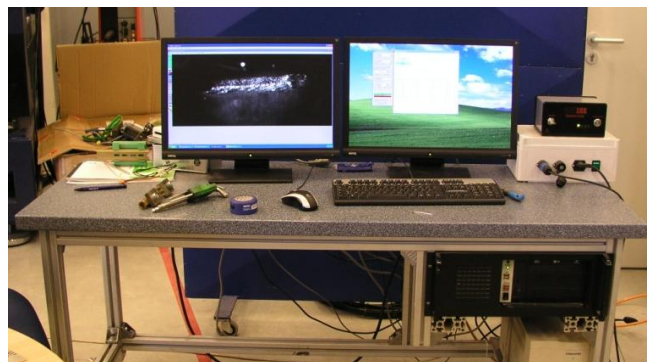
Abbildung 4-29 Links: Überwachung Hochgeschwindigkeitskamera, rechts: Stromquelle des Beleuchtungslasers
