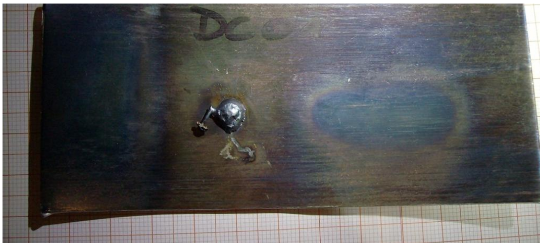
Abbildung 5-8 Auftragsschweißung auf der Stahlseite des Bimetalls
