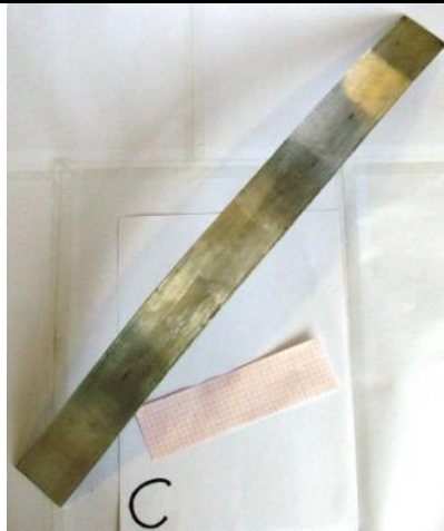
Probe C Aluminium und Stahl haften aufeinander.
