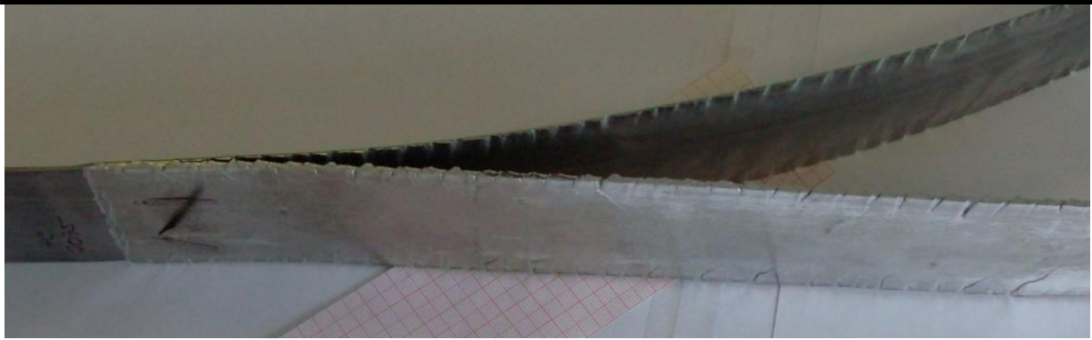
Einrisse entlang der Blechkanten
