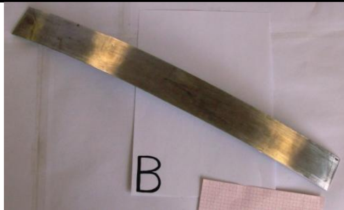
Probe B Aluminium und Stahl haften aufeinander.
