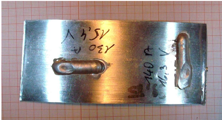
Abbildung 5-7 Auftragsschweißung auf der Aluminiumseite des Bimetalls
