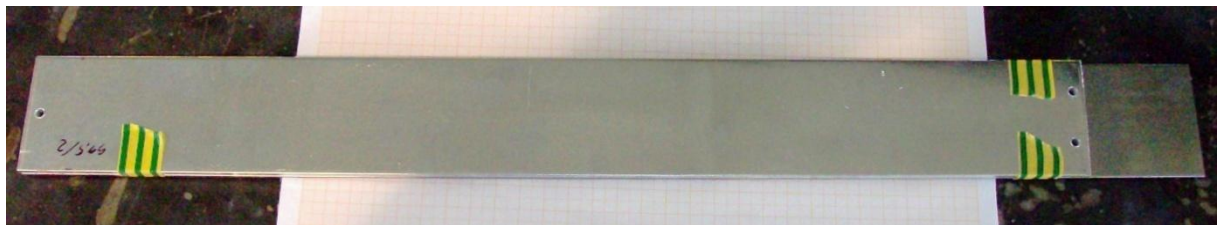
Abbildung 4-5 Zugeschnittene Probe mit den gebohrten Löchern zur Sicherung bzw. Befestigung
