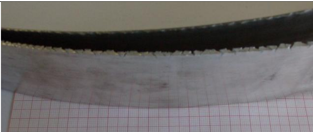
Einrissbreite nimmt stetig bis zum Ende des Streifens zu
