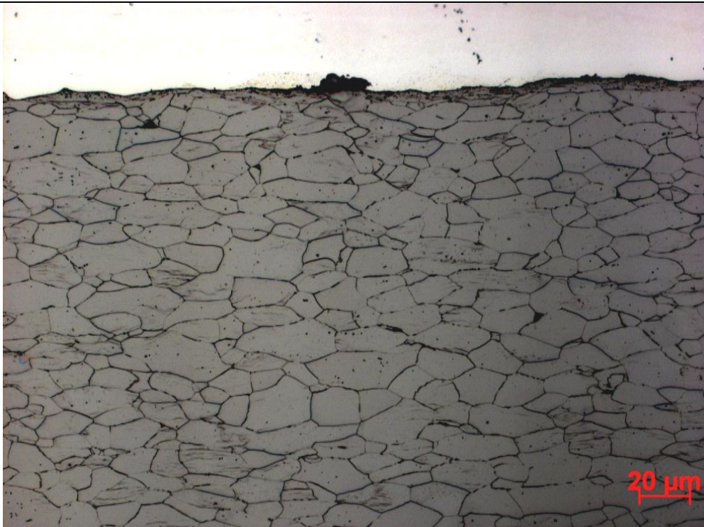
Geätztes ferritisches Gefüge im Stahl
