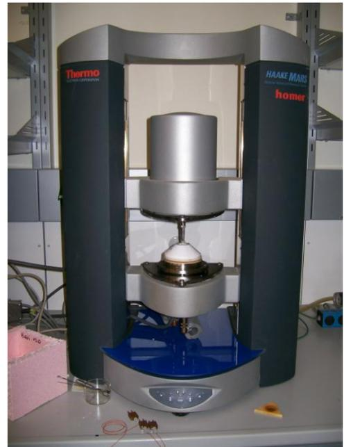
**Abbildung 4-7: *Dynamic Shear Rheometer***
