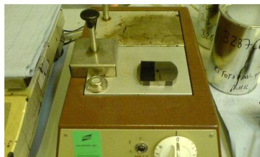
**Abbildung 4-4: Beschichtetes Blech auf das Aufschmelzgerät**
