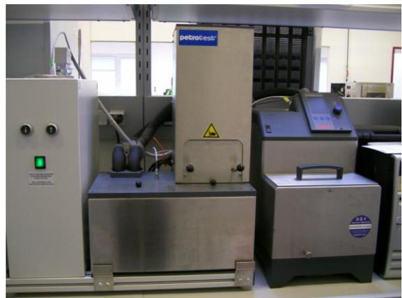
**Abbildung 4-13: Bending Beam Rheometer**
