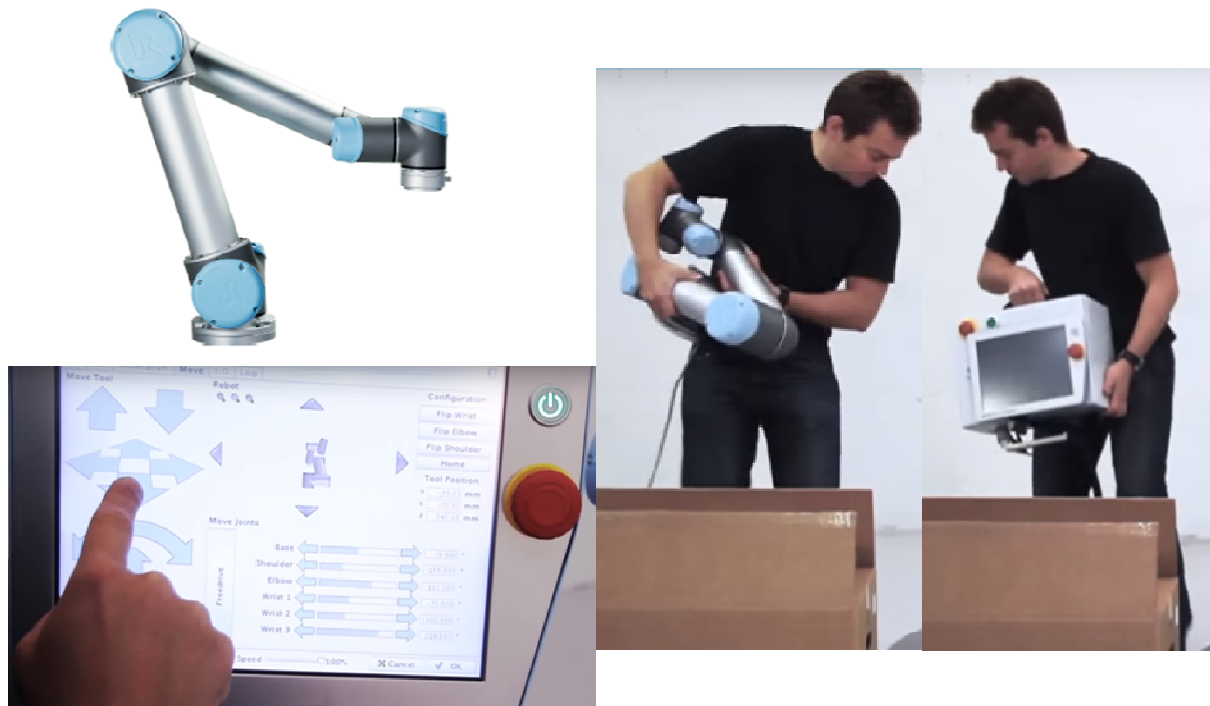
Abbildung 9: UR-Reihe Produktdarstellung: Bild links oben – Darstellung des UR3; Bild rechts – Transport des UR5 und des zugehörigen Steuerungsgerätes; Bild links unten – Beispielhafte Darstellung des Bediengerätes und der Bedienoberfläche 23
