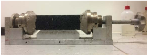
Abbildung 11: Einspannen eines Probekörpers
