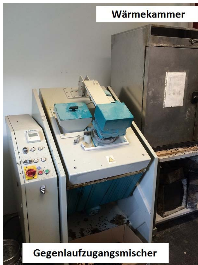
Abbildung 8: Prüfgeräte bei der Drehmomentmessung
