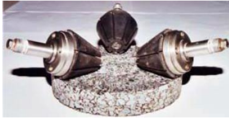
Abbildung 32: Simulation der Verkehrsbeanspruchung [Donchev, 2007]
