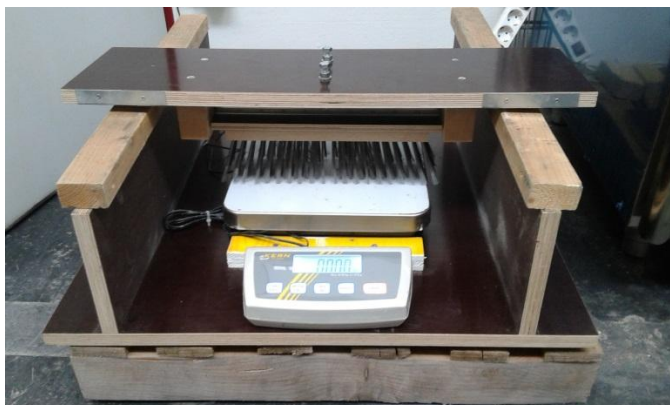
Abbildung 18: Einstellung des Anpressdruckes
