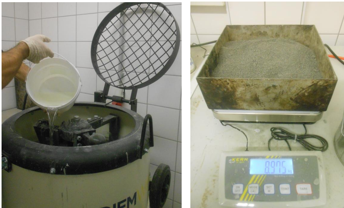
Abbildung 13: Mischen des Betons
