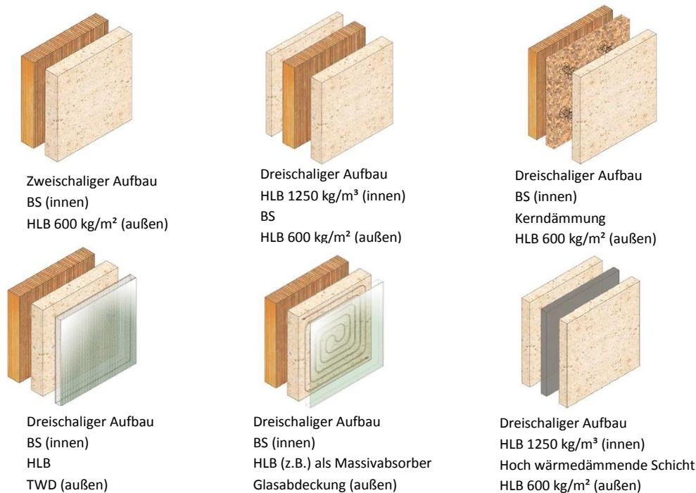
Abbildung 3 Außenwandaufbauten mit Holzleichtbeton, Quelle: Krippner 2004
