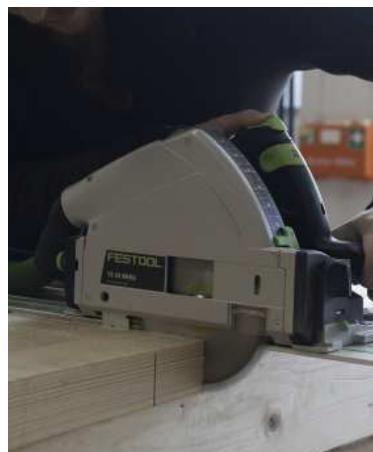
3.35 Einschneiden mit der Tauchsäge
