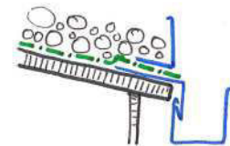
3.164 Skizze zur Montage der Kiesfangleiste und Regenrinne
