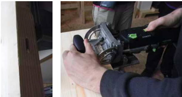
3.73 + 3.74 Fräsloch und Flachdübelfräse
