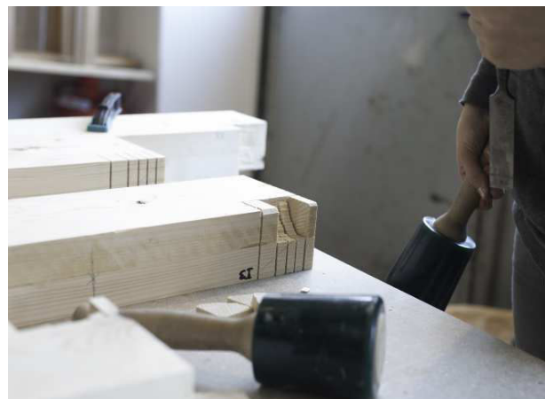
3.40 teilweise ausgestemmter Bereich
