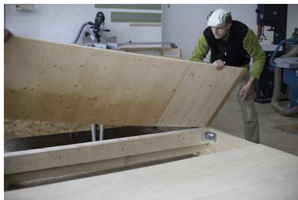
3.143 Dreischichtplatte als Deckenunterseite
