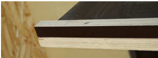
3.10 Schnittkante und Oberflächen einer Siebdruckplatte
