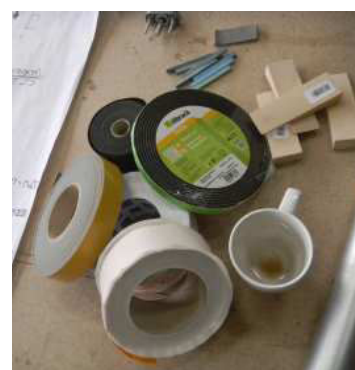
3.248 + 3.249 Dichtbänder für Fenster
