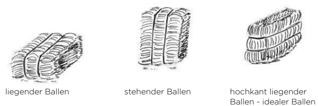
3.126 Einbaurichtungen von Strohballen
