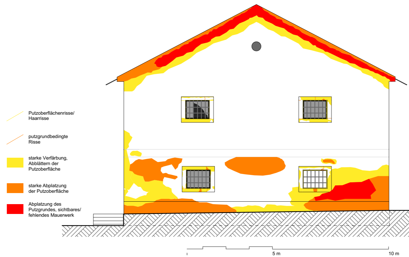
Abb. 59 Schadenskartierung der südlichen Fassade M 1:100
