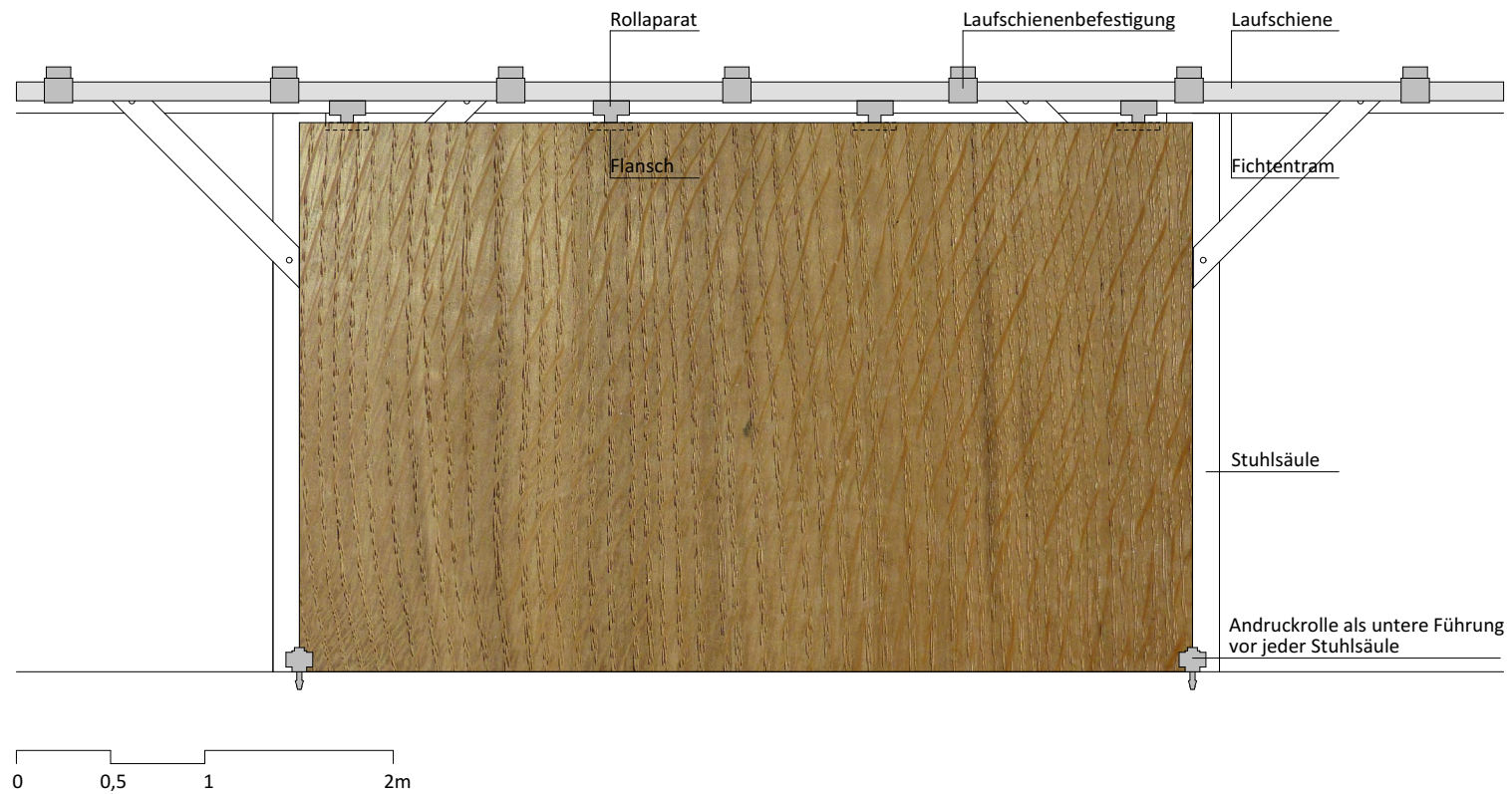
Abb. 163 Montage der Schiebewände
