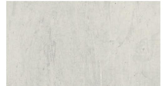
MASSIVE KERNE | Sichtbeton, Zuschlagstoff Sandsteinmehl
