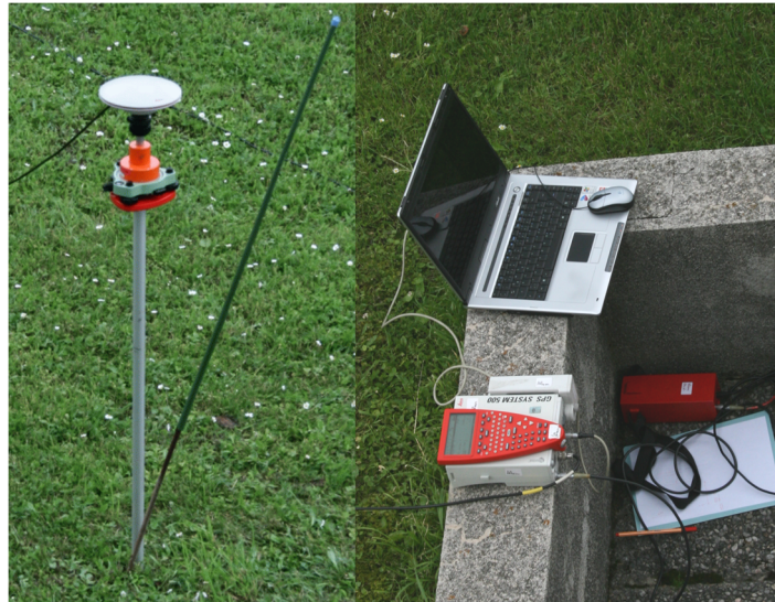
Abbildung 6.20: Messausrüstung der RT-PPP Tests
