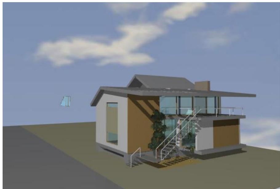
Auf der West-Seite bis zum Boden verlängerte Satteldach schützt das Baukörper gegen West-Wind und der Gaube mit schmale horizontale Öffnung ermöglicht die unerwünschte Wind zu optimieren und in warme Jahreszeit kann die Rolle von Klimaanlage übernehmen.
