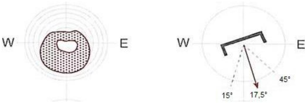
Abb. 5-11 Optimale Gebäudeausrichtung in gemäßigter Klimazone
