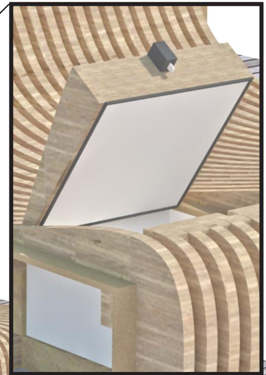
Das Strandliege- und Sitzelement ist als ein Ergonomischelement geplant. Im Element ist auch ein Lockersystem integriert, das mit einem wasserdichten Magnetarmband gesperrt ist. Das Schließfach hat ein Dichtungsband, sodass er, wenn gesperrt, voll wasserdicht ist.
