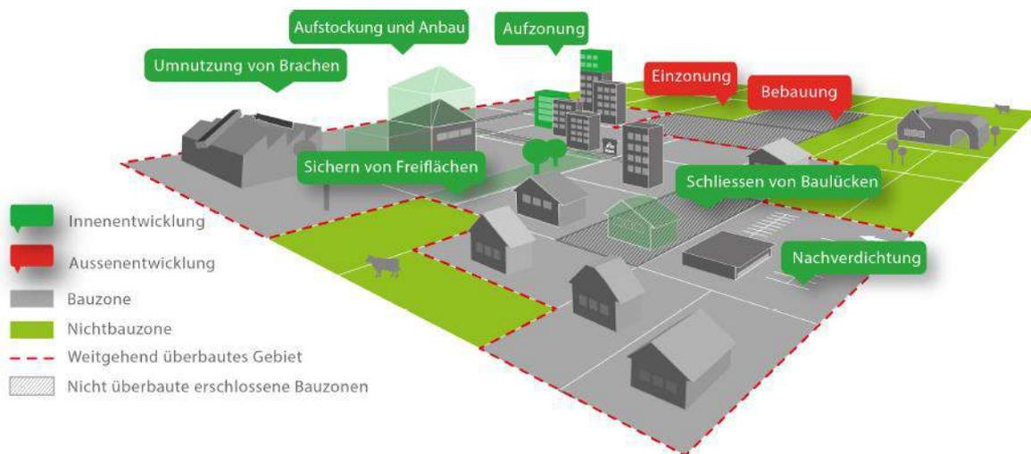
**Abbildung 5: Schema der Innenentwicklung und Außenentwicklung, Quelle: (Grams, 2015 S. 15) basierend auf ETH Zürich, 2012:3**
