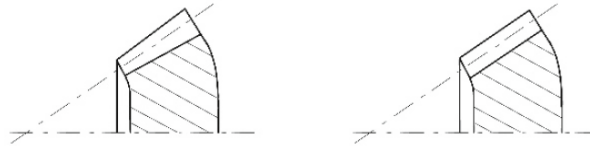
Abbildung 2 - Veränderliche (links) und konstante (rechts) Zahnhöhe (Quelle: Klingelnberg, 2008, S.12)
