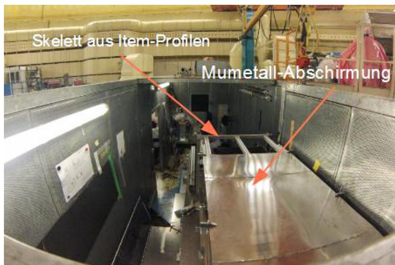
**Abbildung 4.14.** – Aufgebaute Mumetall-Abschirmung am PF2 Messplatz in Grenoble.
