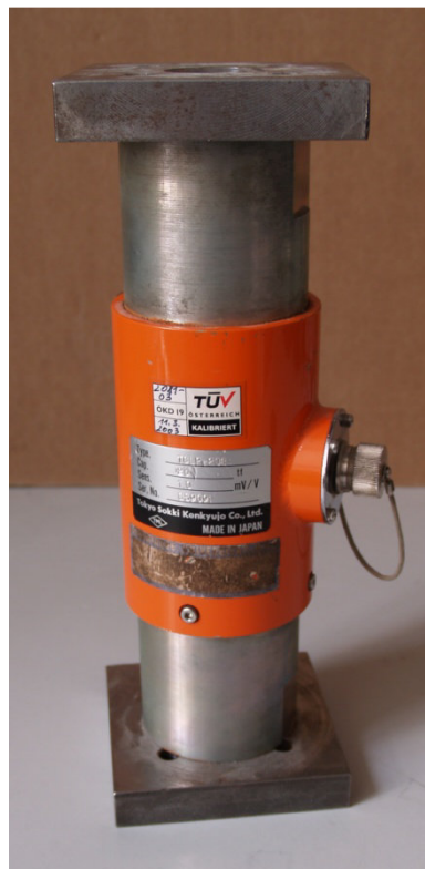
Abb. 3.9: Kraftmessdose der Typenreihe TCLP-20B der Firma Tokyo Sokki Kenkyujo co. Ltd
