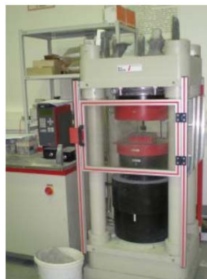
Bild 5.4: Maschine Fa. TONI Technik Modell 2040 zum Messen der Druckfestigkeit (4)
