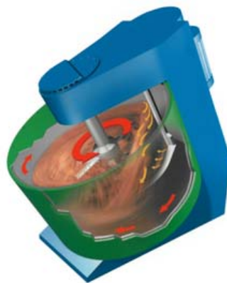
Bild 2.10: Darstellung eines Eirich-Mischers (28)
