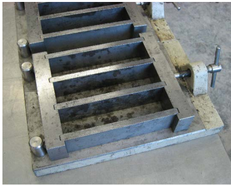
Bild 5.2: (links) Schalungen mit 4 x 4 x 16 cm
