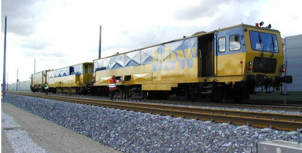
Abb. 11: Schienenschleifmaschine (rhombegrail.com, Seite „Maschinen“)
