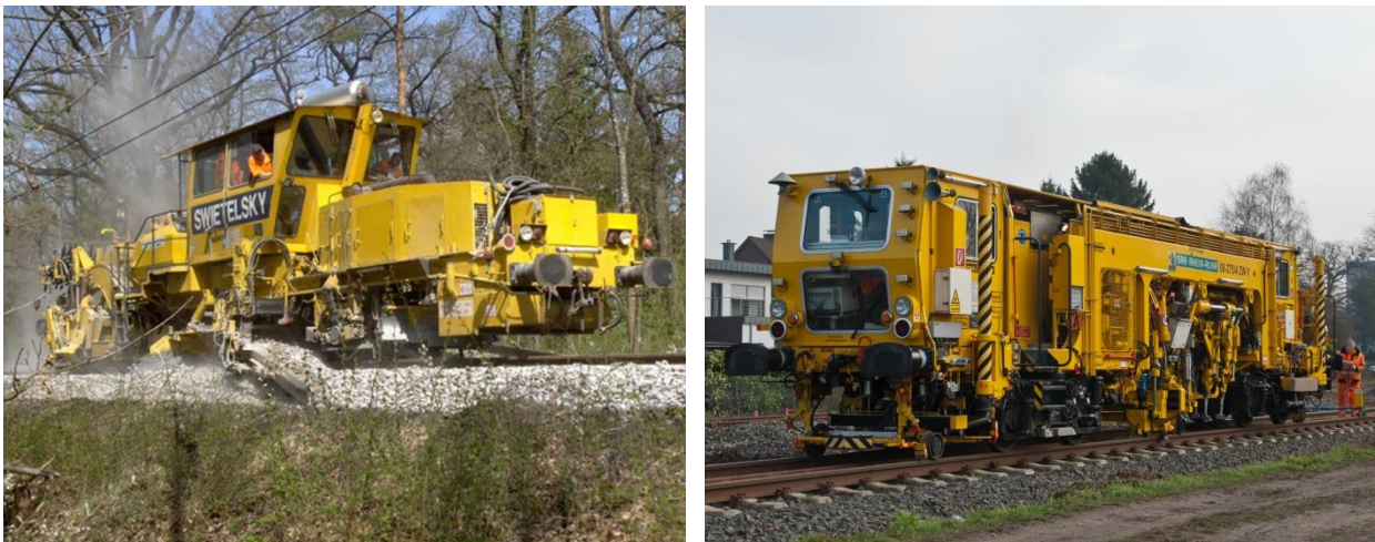
Abb. 12: Links: Schotterpflug ( lechfeldbahn.de ); rechts: Stopfmaschine ( plassertheurer.com )
