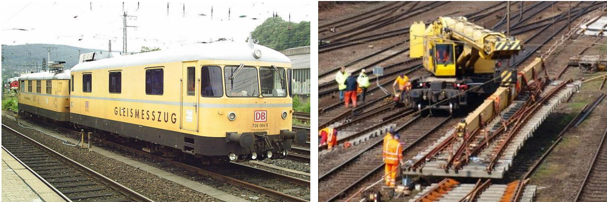
Abb. 15: Links: Gleismesszug ( http://de.wikipedia.org/wiki/Gleismesswagen ); rechts: Gleisbaukran ( bahnbilder.de )
