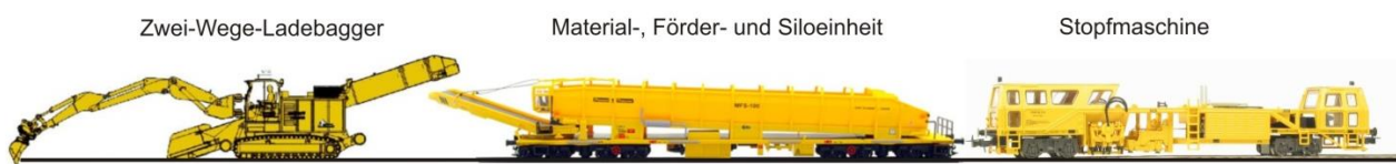
Abb. 16: Bauzug mit Zwei-Wege-Bagger, MFS-Einheit und Stopfmaschine (Einzelbilder von: vanoli-ag.ch; modellbahnshop-lippe.com; miniaturmodelle.net)
