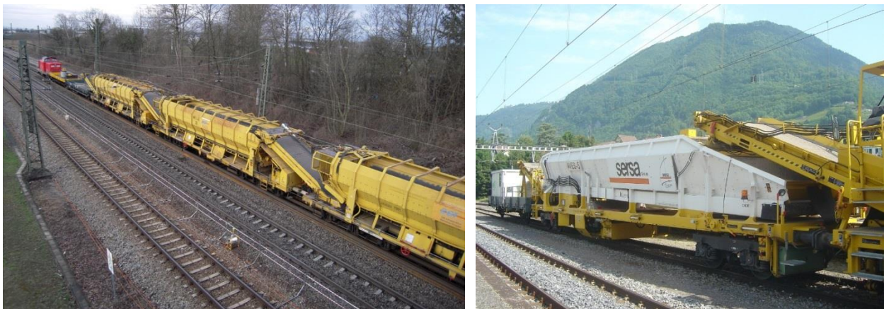
Abb. 14: Materialförder- und Silowagen (links: stummiform.de ; rechts: vanoli-ag.ch )
