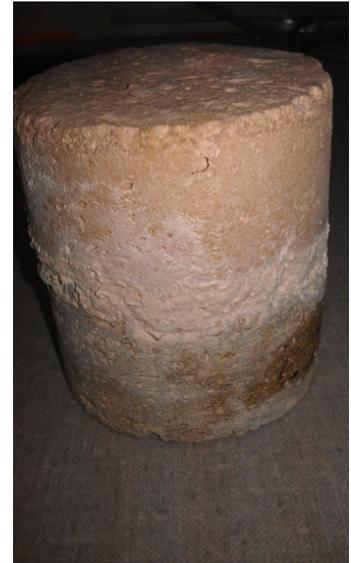
*Abb. 77, 78 und 79 - die Salzkristallisation an den Prüfkörpern CS01, CS02, CS03 (von links nach rechts) – beim Roman-Zement tritt diese am Mörtel im Verbundbereich zwischen Stein und Ergänzungsmörtel auf*
