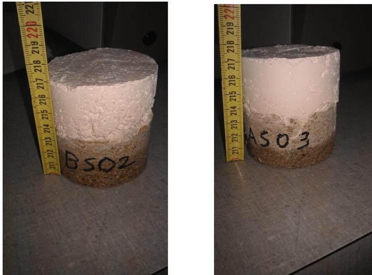
*Abb. 25 (links) und 26 (rechts) – der unterschiedlich hohe Feuchtehorizont bei verschiedenen Prüfkörpern*
