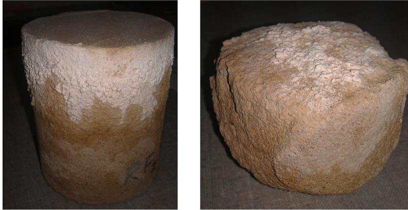
*Abb. 91 und 92 - Salzkristallisation der Referenzkörper RF2S01 und RF2S02 (von links nach rechts)*
