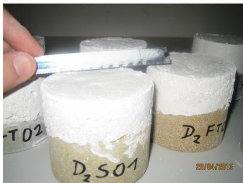
*Abb.17 – Anrauen des Mörtels vor Anbringung des Feinmörtels*
