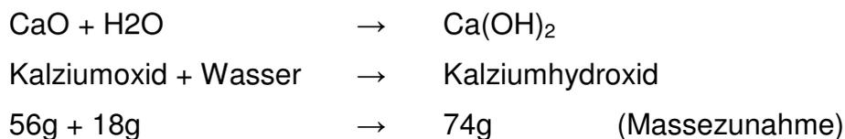
Wie man erkennt, kommt es zu einer Massenzunahme von ca. einem Drittel, da jedoch eine gewisse Wassermenge verdampft und auch als ungebundenes Wasser erhalten bleibt – wird für die Herstellung von gelöschtem Kalk ca. 50% der Branntkalk-Masse an Wasser benötigt.
