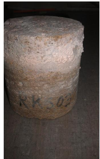
*Abb. 80, 81 und 82 - die Salzkristallisation der Referenzkörper RKS01, RKS02, RKS03 (von links nach rechts)*
