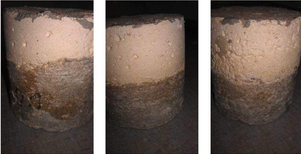
*Abb. 99, 100 und 101 - die Salzkristallisation an den Prüfkörpern AFT01, AFT02 und BFT01*
