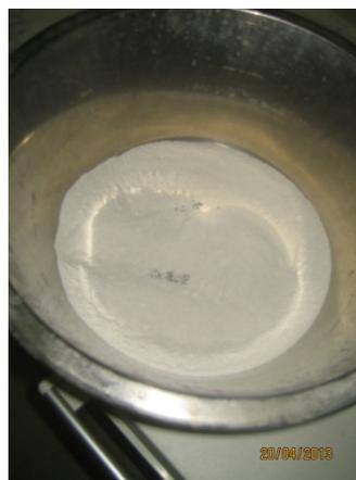
*Abb. 16 – Weiss-Zement und gelöschter Kalk in einer Schale vor der Durchmischung*
