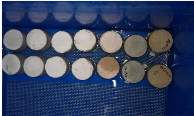
Abb. 93 - die Prüfkörper in der Salzlösung
