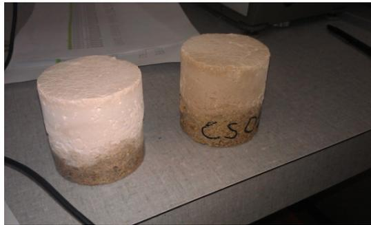
*Abb. 22 – zwei Roman-Zement Prüfkörper im Vergleich: Deutlich zu erkennen, dass nur bei der rechten Fassung (CS02) der Mörtel feucht und daher dunkler ist*
