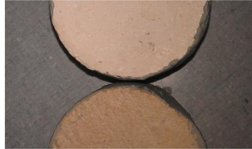
Abb. 29 (links) und 30 (rechts) – die Prüfkörper CFT01 im Vergleich mit der Fassung CFT02 nach Abschluss des Versuchs zur kapillaren Wasseraufnahme – ein deutlicher Farbunterschied zufolge der Befeuchtung an CFT01 (Abbildung 29 links; Abbildung 30 unten) ist zu erkennen
