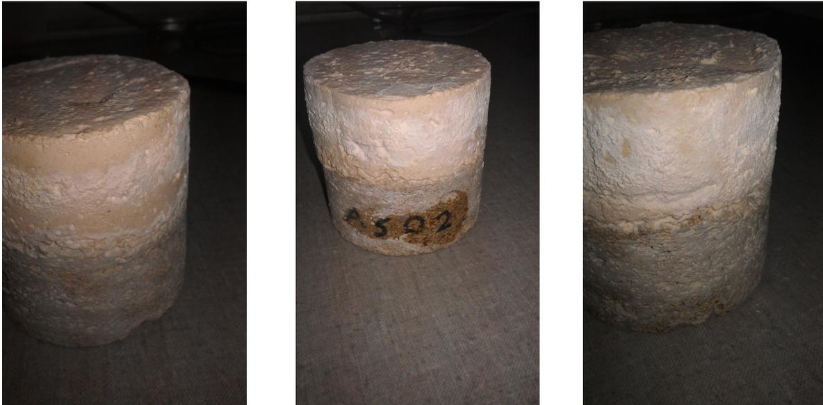
*Abb. 71, 72 und 73 - die Salzkristallisation ist deutlich an den Zylindern AS01, AS02, AS03 (von links nach rechts) zu erkennen*
