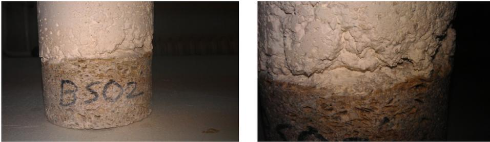
*Abb. 46 und 47 – Salzkristallisation des Prüfkörpers BS02 im Bereich des Kaisersteins und an der Verbindungsstelle zwischen Mörtel und Stein nach zwei Zyklen)*
