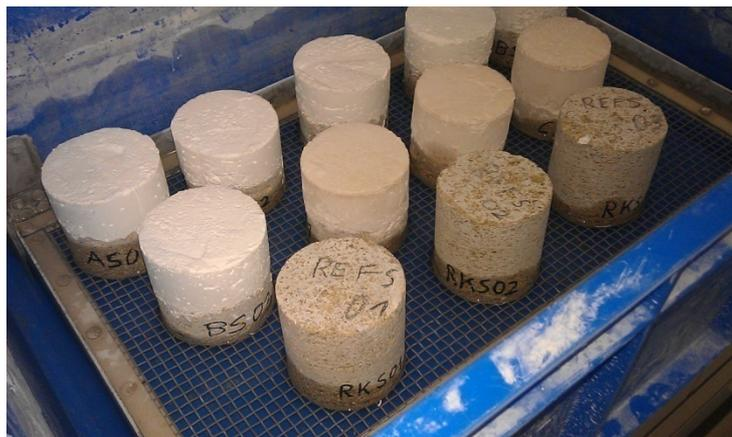
*Abb. 27 – das Wasserbad; der Prüfkörper CS02 ist im Hintergrund zu erkennen (mittlere Reihe, zweite von rechts) – die Feuchtigkeit steigt bereits in dem Mörtel auf*
