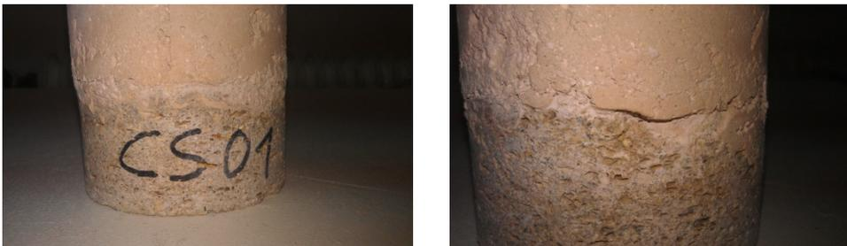
*Abb. 48 und 49 – Salzkristallisation des Prüfkörpers CS01 im Bereich des Kaisersteins und an der Verbindungsstelle zwischen Mörtel und Stein nach zwei Zyklen*
