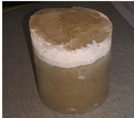
*Abb. 89 und 90 - Salzkristallisation der Referenzkörper RF1S01 (der Zylinder war nicht vollständig von der Salzlösung bedeckt) und RF1S02 (von links nach rechts)*
