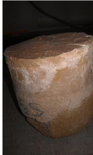
*Abb. 87 und 88 - Salzkristallisation der Prüfkörper E1S01 und F2S01 (von links nach rechts)*
