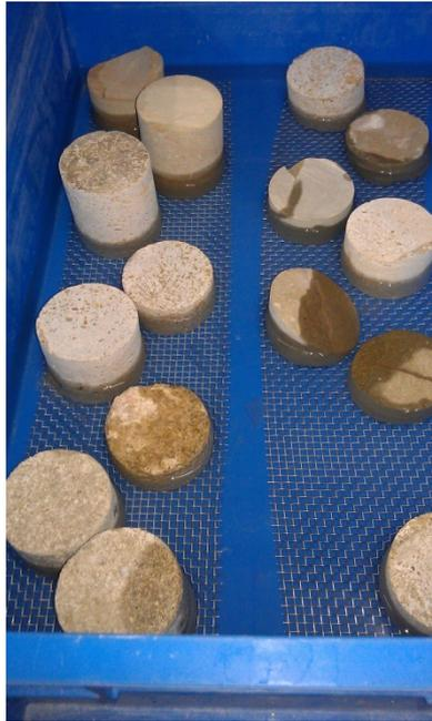
*Abb. 39 – das Becken vor dem Einlegen der Prüfkörper, um einen Anstieg des Wasserspiegels zu verhindern wurden diese Körper nach und nach entfernt, damit durch das verdrängte Volumen der Wasserspiegel nicht steigt*
