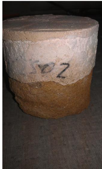
*Abb. 85 und 86 - Salzkristallisation an den Prüfkörper D2S01 und D2S02 (von links nach rechts)*
