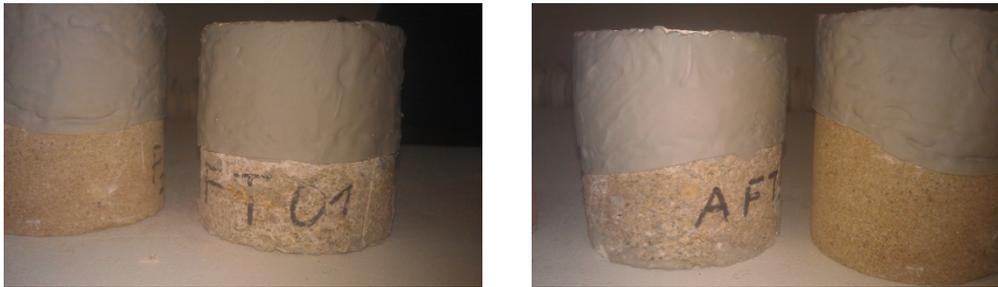
*Abb. 97 und 98 - Prüfkörper nachdem die Beschichtung am Stein entfernt wurde*
