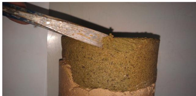
*Abb. 56 (links oben) – selbst beim Trocknen mit dem Tuch konnten Teile des Prüfkörpers E2S01 bereits nach der fünften Kristallisation gelöst werden*
