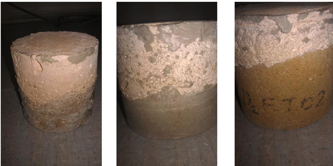
*Abb. 102, 103 und 104 - die Salzkristallisation an den Prüfkörpern CFT02, D1FT02 und D2FT02)*
