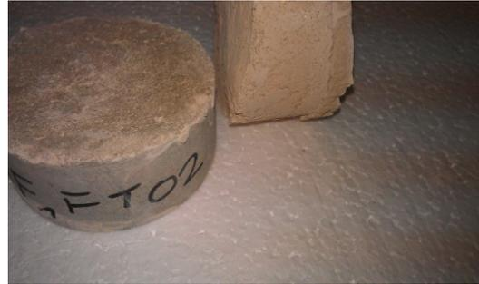
*Abb.18 und 19 – die zerfallenen Prüfkörper aus Roman-Zement*
