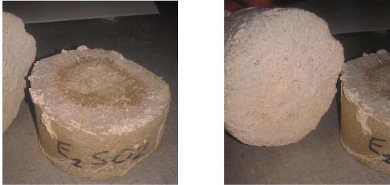
*Abb. 61 und 62 –Prüfkörper E2S02 nach dem Ablösen des Mörtels vom Stein*
