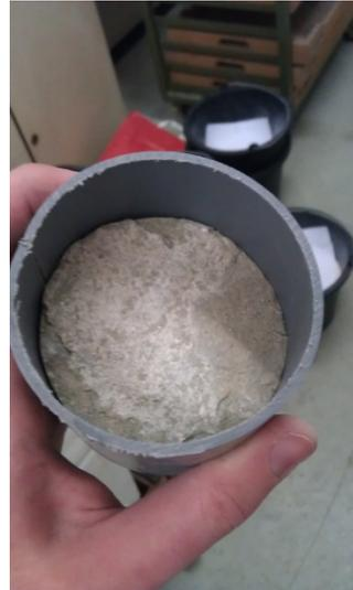
*Abb. 14 und 15 – das Polokalrohr als Schalung und ein Bohrkern vor Aufbringen des Ergänzungsmörtels*
