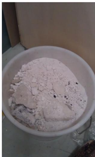
*Abb. 13 – der ungelöschten Kalk in noch ungesiebter Form*
