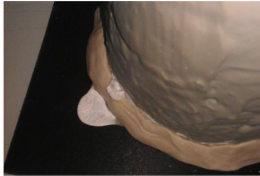
*Abb. 94 - Salzkristallisation an der Abdichtung*
