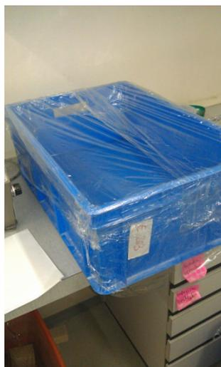
*Abb. 45 – vorbereitetes Becken gefüllt mit der Magnesiumsulfatlösung*
