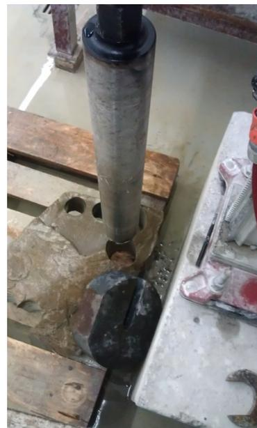
*Abb. 9 (rechts) – ein Quarzsandstein während dem Ausbohren der Zylinder*
