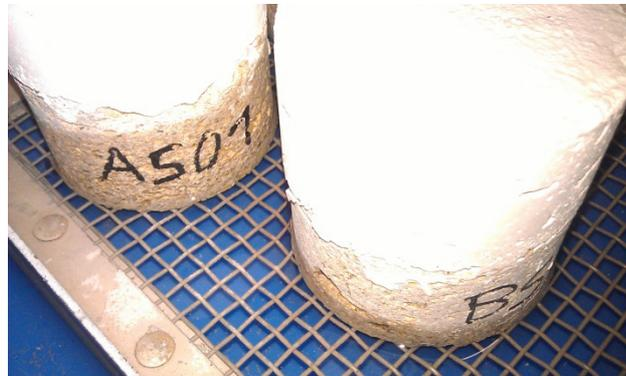
*Abb. 23 (rechts) – der Feuchtehorizont ist bei dieser Versuchsreihe bei dem Prüfkörper BS02 weit von der Mörtelschicht entfernt*
