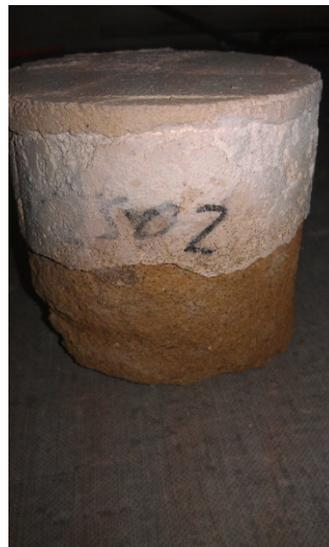
*Abb. 69 (links) – F2S01 nach der 20. Salzkristallisation; Schäden am Quarzsandstein 2 vor allem im Kantenbereich, sowie eine bereits deutlich erkennbare rauere Oberfläche*
