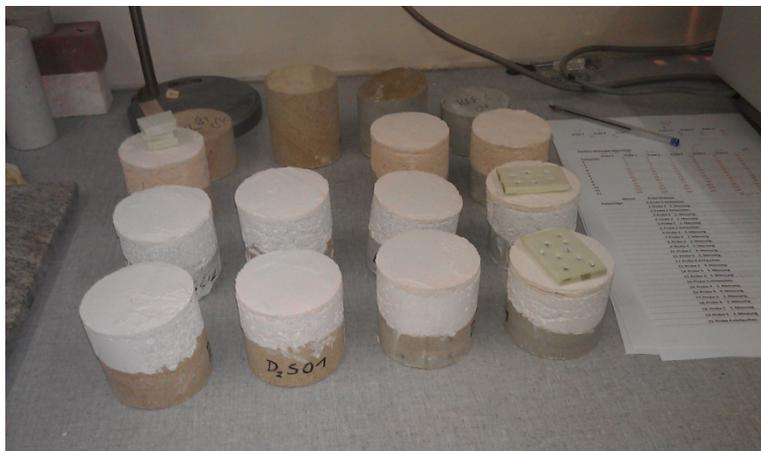
*Abb. 38 – die Prüfkörper vor der Versuchsdurchführung, die benötigten XPS-Polster mancher Prüfkörper liegen bereit*
