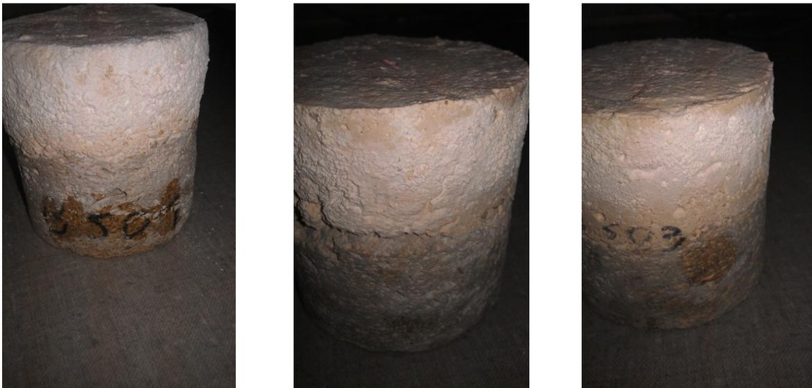
*Abb.74, 75 und 76 - die Salzkristallisation ist deutlich an den Prüfkörpern BS01, BS02, BS03 (von links nach rechts) zu erkennen, an dem Prüfkörper BS01 trat die größte Salzkristallisation auf*
