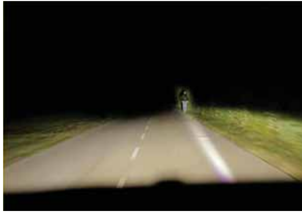
Abbildung 1.6: Markierungslicht leuchtet gezielt Fußgänger am Straßenrand an [14]
