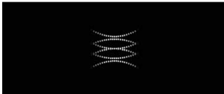
Abbildung 4.7: Dimmwerte der sechs Laserstrahlen am Phosphor für gleichmäßige Helligkeitsverteilung
