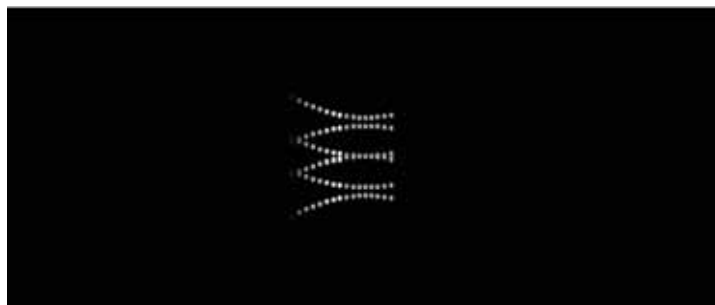
Abbildung 4.9: Intensitätswerte der sechs Laserstrahlen am Phosphor für die bestimmte Helligkeitsverteilung 4.8
