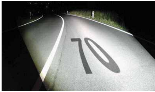
Abbildung 1.8: DMD: variable Lichtverteilung [19]
