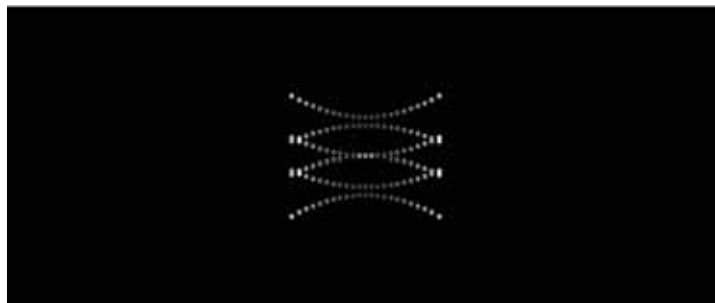
Abbildung 4.6: Kurven der sechs Laserstrahlen am Phosphor mit Berücksichtigung des mehrmaligen Scannens eines Punktes
