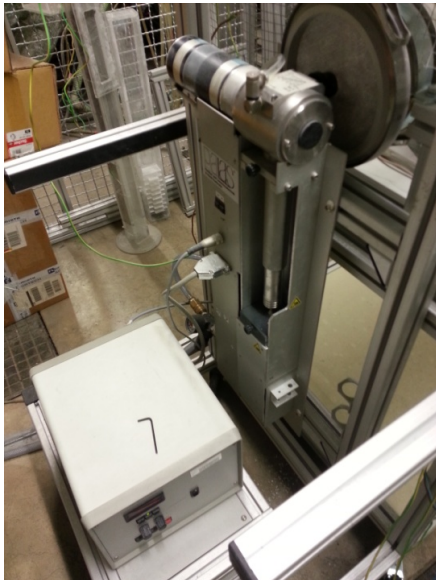
Abbildung 20: Staubdispergierer Palas RGB 2000
