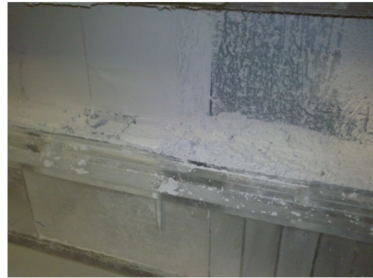
Abbildung 26: Aluminiumabdichtung mit Langlöcher im Elektrodenbereich, Sammelbehälter an Unterseite im gereinigten Zustand (links) und im ungereinigten Zustand (rechts)
