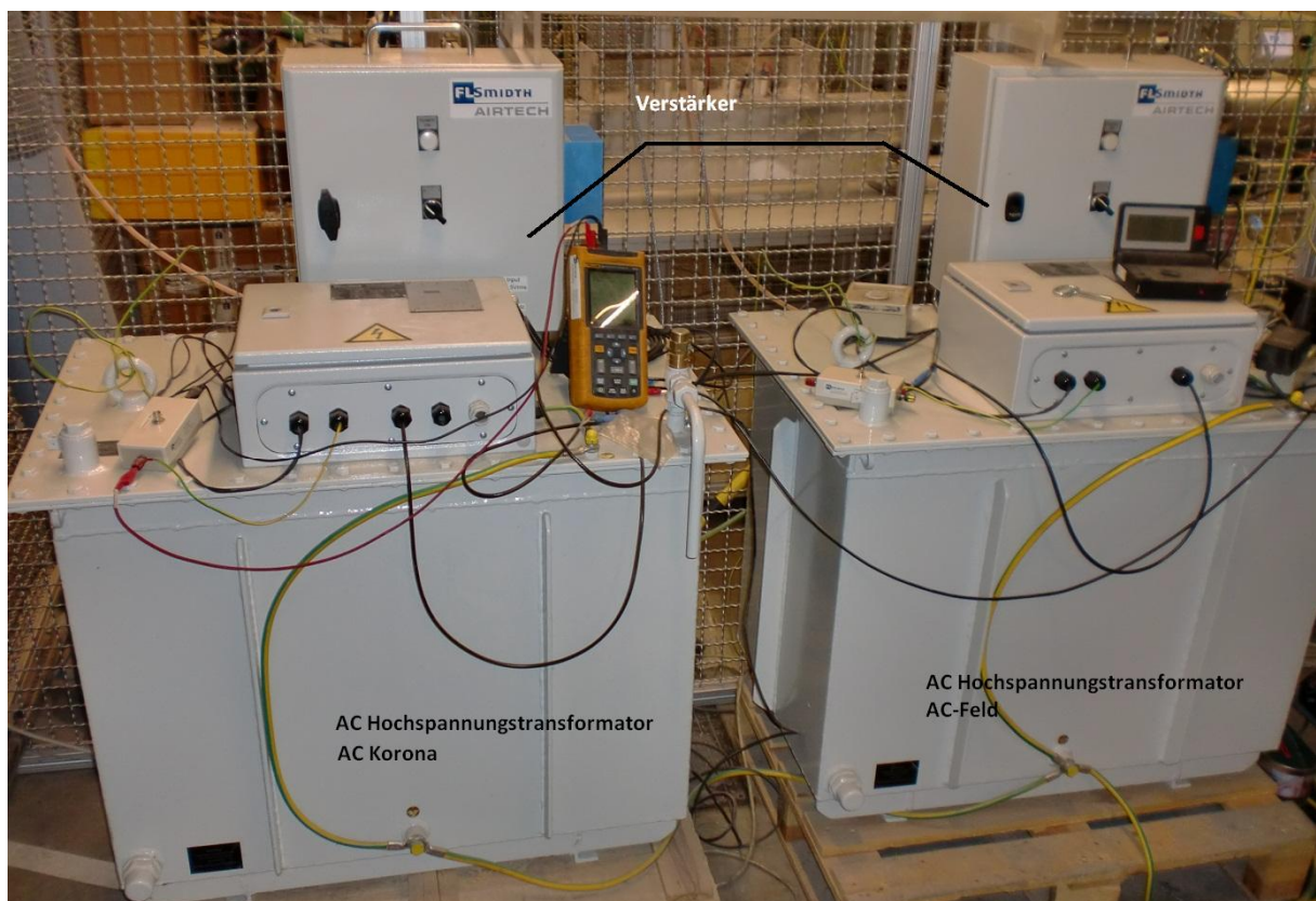
Abbildung 33: AC Hochspannungstransformatoren und deren Verstärker
