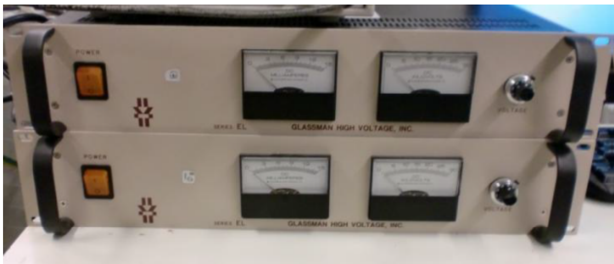
Abbildung 32: Hochspannungsnetzgeräte DC+ und DC-
