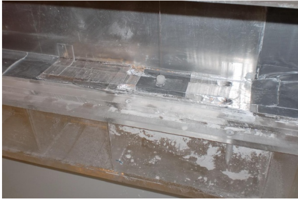
Abbildung 26: Aluminiumabdichtung mit Langlöcher im Elektrodenbereich, Sammelbehälter an Unterseite im gereinigten Zustand (links) und im ungereinigten Zustand (rechts)
