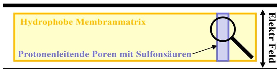
**Abbildung 48:** Schematischer Aufbau zum Ausrichten von Kanälen in der Polymermatrix.
