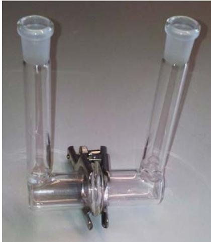
**Abbildung 61:** Diffusionsmesszelle
