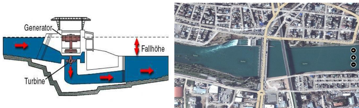
Abbildung 3: Ein typisches Laufwasserkraftwerk schematisch (rechts) [6], Seyhan HES (links)
